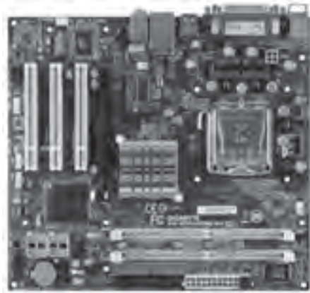
◀ 技嘉 GA-81945GZME-RH 主板省去了很多对于网吧来说不必要的功能，成本也有所降低，同时集成显卡，很适合用来组装入门级的网吧用机。
