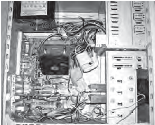
▲ 零乱的内部结构，诸多风扇会让工作环境更加嘈杂
