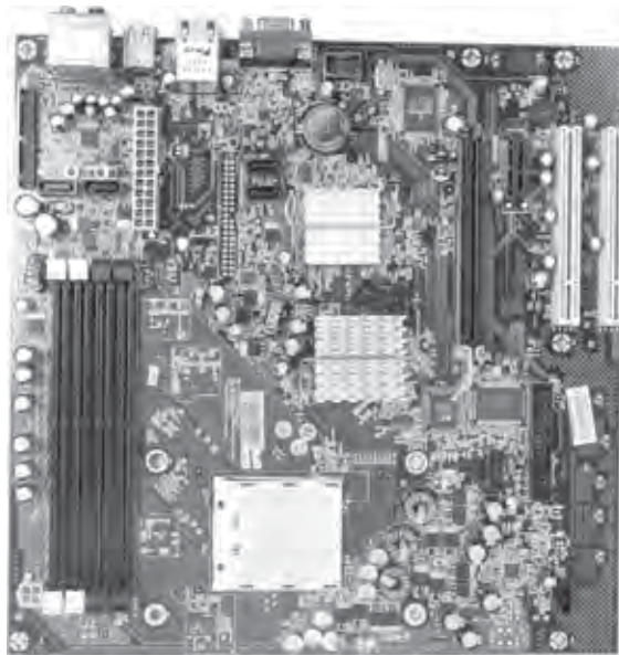
▲Dell Dimension C521主机采用的AM2架构主板
