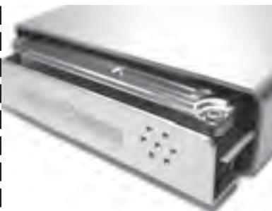
散热孔是保证快速散热量的重要方式
