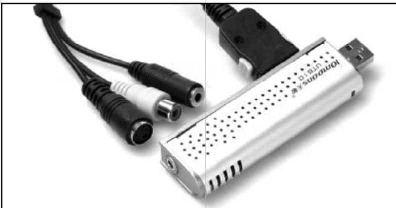
接电源,直接从USB接口取电就可以工作。别看UT810的体积小,该有的接口却绝不含糊——通过一根精致的转接线提供了RF射频接口,机身侧面则通过转接线提供了S-Video输入、音频输入和复合视频输入三个最常用的接口,无论是观看电视节目,还是连接DVD、DV等视频设备都能轻松连接。包装中还附带了一根USB延长线,避免笔记本机身上多个USB接口同时插入设备时相互影响的问题。
