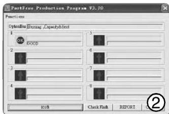
3. 如果 Flash 是好的, 就可以进行低级格式化了, 单击“OPTION”可以设置选项, 主要设置“Flash Text”和“Capacity Adjust”见图 (3) 和图 (4), 图 (3) 中选“Low Level Format”即低级格式化, 在图 (4) 中选“Low Level Format”, 最后单击“RUN”, 进行低级格式化, 低格的速度比较慢, 格式化好的界面如图 (5)。
