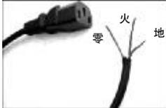
**第二步，**将主机的电源从机箱内卸下打开，找到其交流电输入接插件后的焊点，将准备好的电源输入线并联焊接在各个对应的焊点上，焊好的电源输入线与电源内的直流输出线一起从电源的出线孔穿出，见图。
