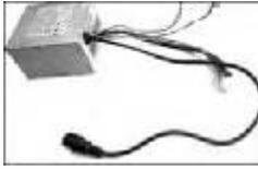
**第三步，**找出第二电源的20/24 Pin插线中的绿线(PS-ON)，位置如下图所示，将它从插件上剪下并分离出来，线头去皮上焊锡。将主电源的这根绿线也找出，不要将它剪断，只在其中间位置去一段皮(用电烙铁可以方便地将外皮烫软后去除)，然后将第二电源的PS-ON线端与主电源的中间去皮段相焊接。为了保证两个电源输出的直流电源具有相同的参考“地”，有必要将两个电源的“地线(任意一根黑线)”也用同样的方法相连接。完成后用绝缘胶布将接口裹起来，防止漏电。
