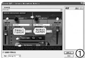
中选择实际使用麦克风的品牌, 如果是杂牌货就选择“bypass mic”; 在“Modeled Mic”中选择某种品牌的麦克风, 这样输出的音效就会最大程度地模拟出此种麦克风的音效, 在这里列举了上百种品牌的麦克风, 几乎可以满足您的各种需要。
