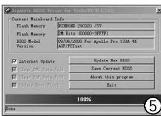
从图5@BIOS界面可以看到软件的一些基本信息,如软件适用于哪些版本的Windows操作系统,能自动侦测出主板的BIOS芯片类型、电压、容量和版本号。
