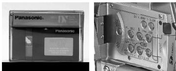
首先将清洗带装入DV中,然后把DV设置为播放状态。按播放键或录制键,以正常的速度走带,不要快进或快倒。播放大约5至10秒钟左右后停止,然后取出清洗带,这样就完成了一次清洗工作。
