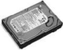
**点评:**全新的盘体及架构设计更加科学合理,正面覆盖了一块厚实的金属顶盖,在有效保护磁盘的同时也加强了整体的散热效果,平均寻道时间为8.5ms,而且采用希捷公司专利的SoftSonic液态轴承马达技术,工作噪音仅28db。
