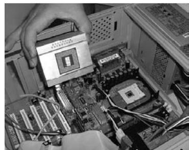
另外, 在类似 Pentium 4 这样的散热面积比较大的处理器上, 有色硅脂的用量也不要太多, 因为这些硅脂的硅油成分相对较少, 黏稠度较高, 在使用一段时间后, 有可能在拆卸散热器的时候, 出现把 CPU 从 Socket 插槽上连根拔起的意外, 无论是对主板还是对 CPU 本身, 这都是一个带有非常大破坏力的潜在危险, 为了你的 CPU 能长命百岁, 还是慎重些吧!
