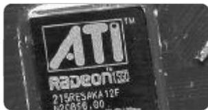
ATI Radeon X500和Radeon X300的图形核心是一样的,虽然它们的制作工艺差不多,但是测试中我们发现,Radeon X550的工作频率要比Radeon X300高得多,而且Radeon X550的超频潜力很大。可以说Radeon X550是高频版的Radeon X300产品,而且它像Radeon 9550一样容易超频。
