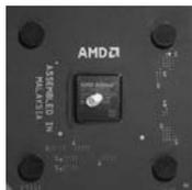
在散热器的挤压下, 硅脂会向四周扩散, 从而覆盖核心。对于使用掺有导电金属的“有色”硅脂的用户来说, 这点非常重要。
