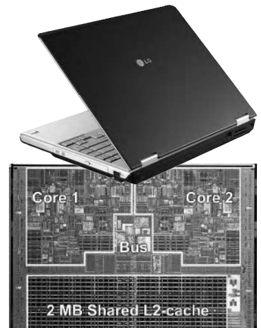
Yonah 处理器内部的两个核心共享 2MB 二级缓存
