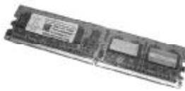
**点评:** 选用了优质的原厂内存颗粒, 采用 FBGA 封装工艺和 1.8V 的超低电压, 能在高速工作中提供上佳的稳定性与散热性。
