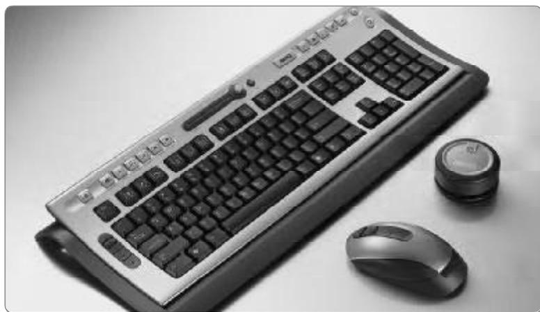
AM730 无线 RF 宝马键鼠套装的设计理念源自 BMW 汽车，这个无线键盘鼠标套装中的键盘采用了典型的“海湾”结构设计，整个键盘的侧面呈弧形，这种设计的好处在于，当你把手腕放置在腕托上之后，以从手掌到指尖的第一个关节为轴，前两节手指到键盘上边缘和下边缘的距离几乎是相等的，这样敲打起来最为省力，不容易感到疲劳。这款键盘的高度调节也很有特色，与传统键盘通过调整键盘脚部支架的方式完全不同，键盘与底座是分离的，通过一个特别的滑动式底座连接在一起，高度共有 3 档可以选择。
