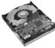
**点评:** 单碟容量达到了125GB, 秉承了日立硬盘的四大技术: 磁头载入载出、重排指令序列、涡流磁臂锁、旋转震动保护。
