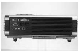
图 6 投影机后部的出风口千万不能有东西阻挡
