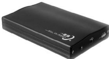
“一盘通”是通过其 PCB 底板上的 CY7C68300A-56PVC 芯片进行 USB2.0 到 ATA/ATAP 的桥连，实现硬盘的 USB 启动的
