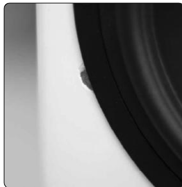
麦博音响局部放大，钢琴漆敲击破损后明显的看到厚度达到 1.5MM
