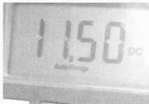
图3-10 万用表显示的11.5V的直流电压
