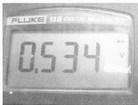
图3-9 万用表显示的某二极管值为534
