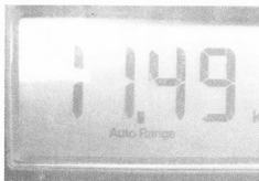
图3-11 万用表显示的11.49kΩ的电阻值
