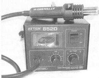
图 3-1 安泰信 852D 数显热风枪
