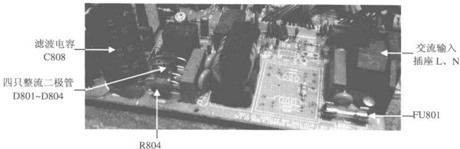
图 4-10 长城彩色显示器电源整流滤波部分元件实物
