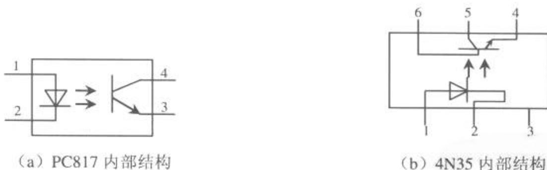
图 3-9 光电耦合器 PC817 及 4N35 内部结构
