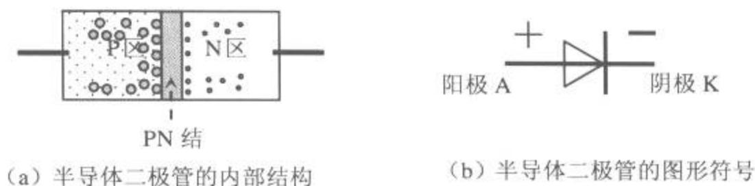
图 1-34 半导体二极管的内部结构及图形符号
