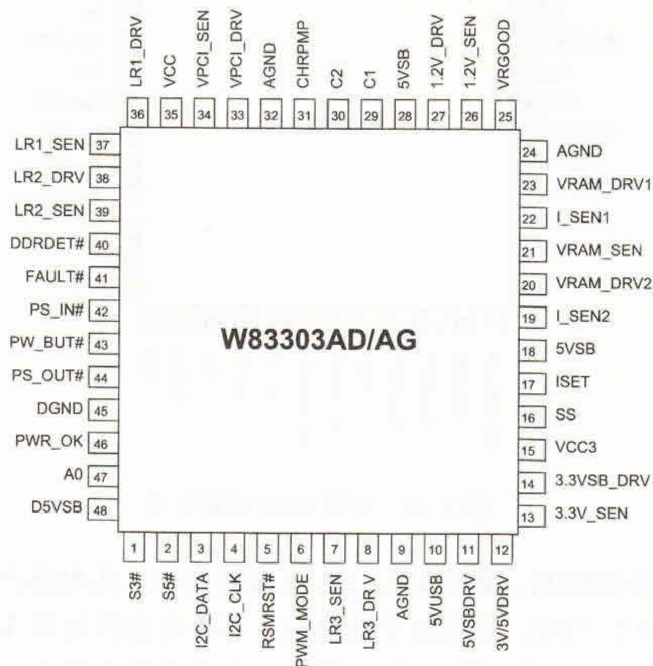
图 2-22 W83303AD 引脚定义
