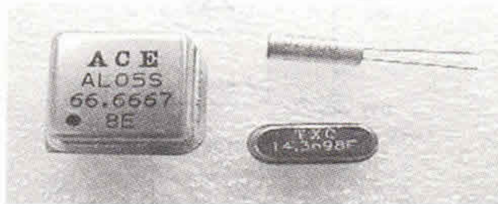
图 1-48 主板上使用的各种晶振
