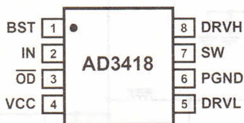
图 3-36 ADP3418 驱动芯片引脚定义
