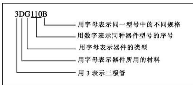
图 2-56 三极管的型号
