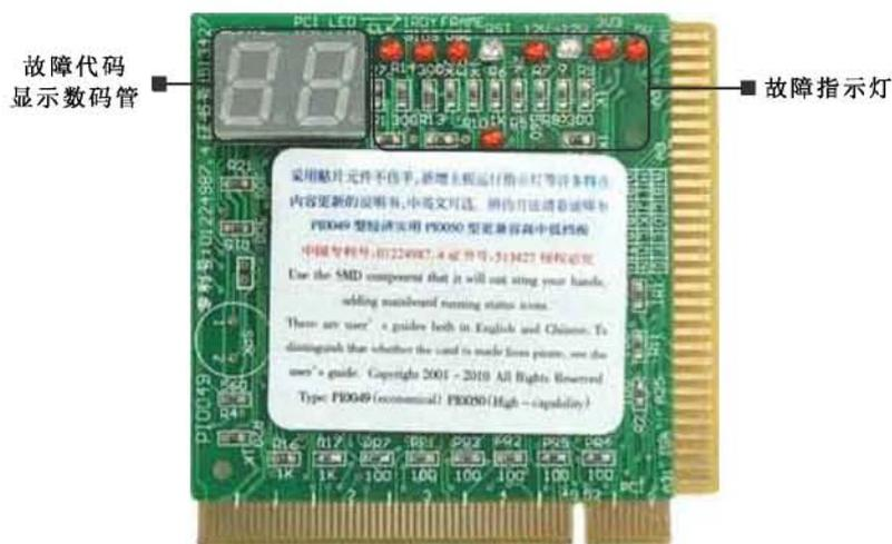
图 2-8 故障诊断卡
