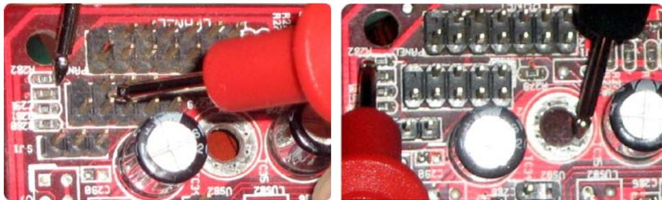
图7-18 测量从电源开关第2脚到电阻
