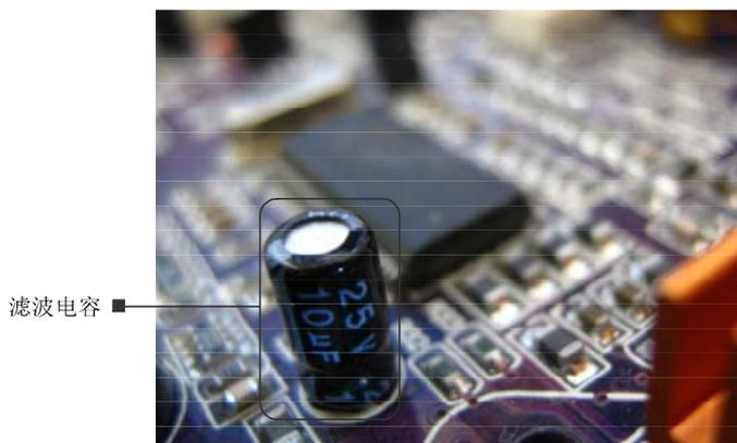
图 9-8 时钟电路中的滤波电容
