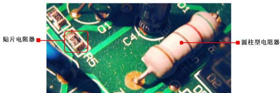
图 2-17 贴片电阻器（左）和圆柱形电阻器（右）
