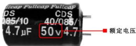
图 2-36 电容器上标注的额定电压
