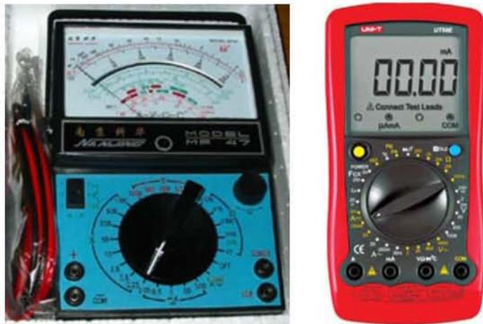
图 2-1 机械指针式万用表（左）和数字式万用表（右）
