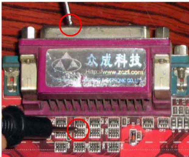
图 5-27 测量连接 472 排阻的针脚
