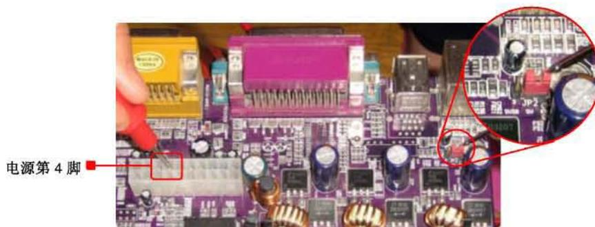
图 5-16 测量电源插座到跳线 JP<sub>1</sub> 的线路
