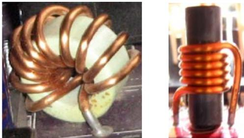
图 8-4 电感线圈 (左边线圈式、右边直立式)
