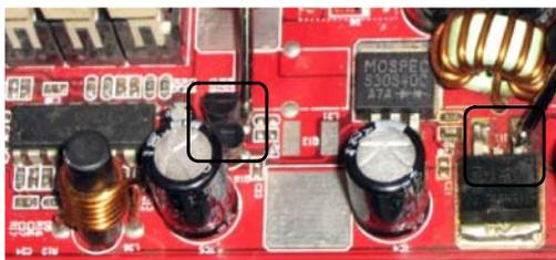
图 8-33 测量场效应管的 G 极连接两个三极管的线路
