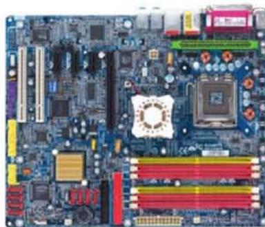
图 1-4 ATX 型主板
