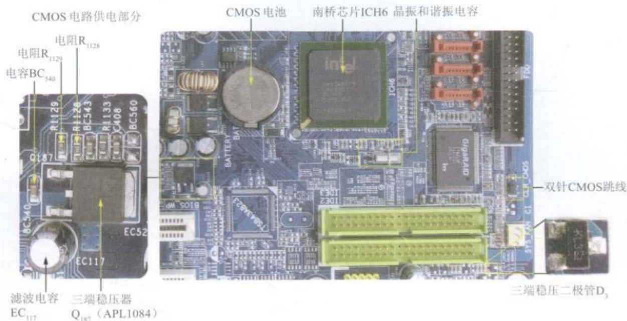
(b) 三端稳压二极管和双针跳线组成的CMOS电路实物图
