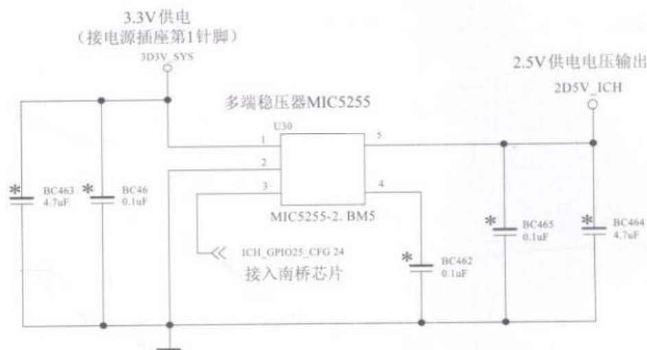
图8-41 由多端稳压器组成2.5V供电电路图
