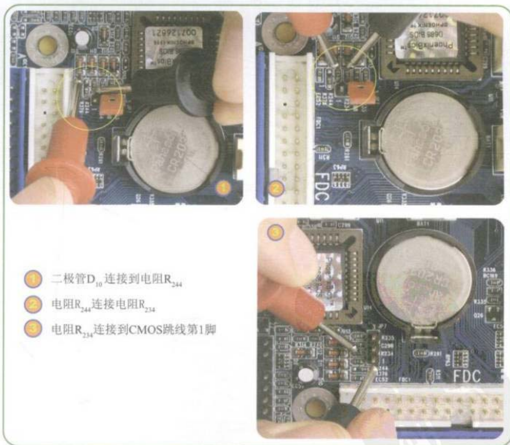
图6-27 测量二极管D 10 通过电阻连接到CMOS跳线的线路
