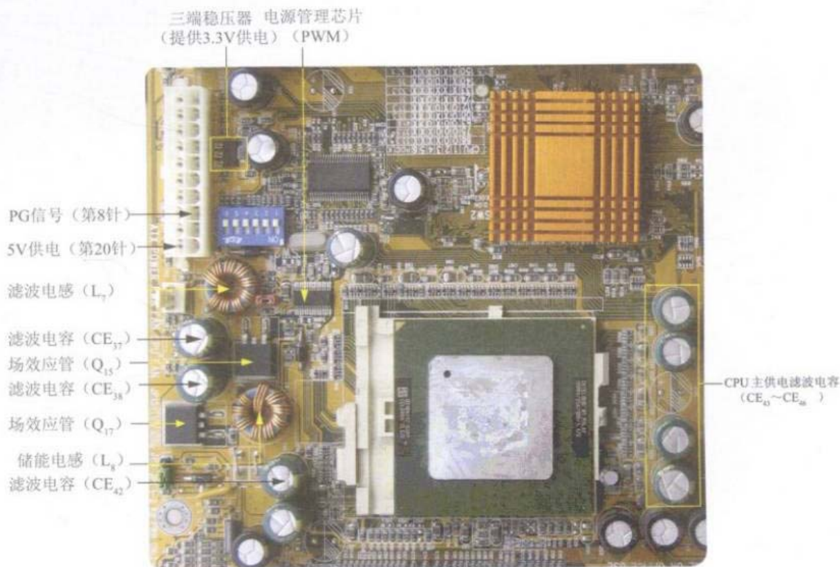
(b) CPU单相供电电路实物图
