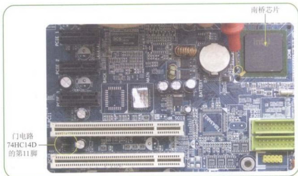
图10-22 测量南桥到门电路74HC14D的第11脚的线路
