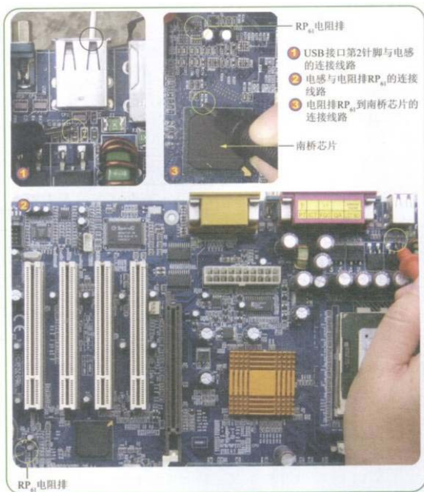
图5-48 测量USB接口插座第2针脚的连接线路
