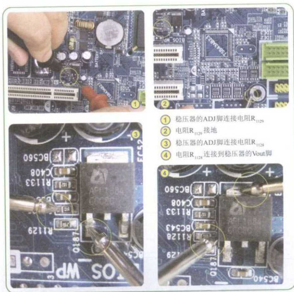
图7-16 测量稳压器ADJ引脚连接的反馈电路到其Vout引脚的线路
