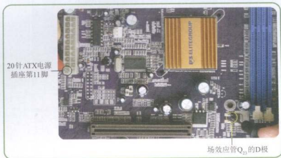
图8-68 测量电源插座第11脚到场效应管D极的线路
