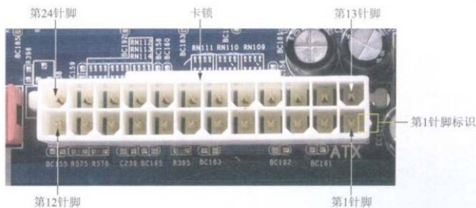
图5-23 24针ATX电源插座引脚顺序
