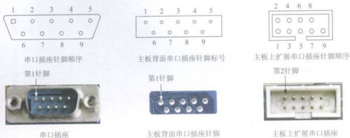
图5-6 串口接口的针脚排列顺序
