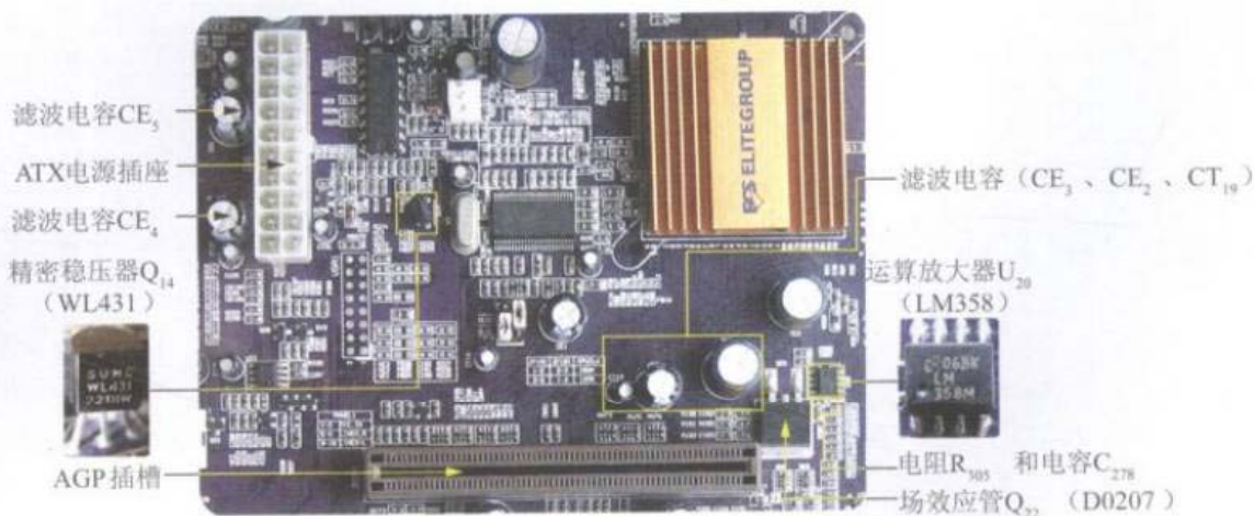
(b) 由运算放大器和场效应管等组成的AGP 1.5V供电电路实物图
