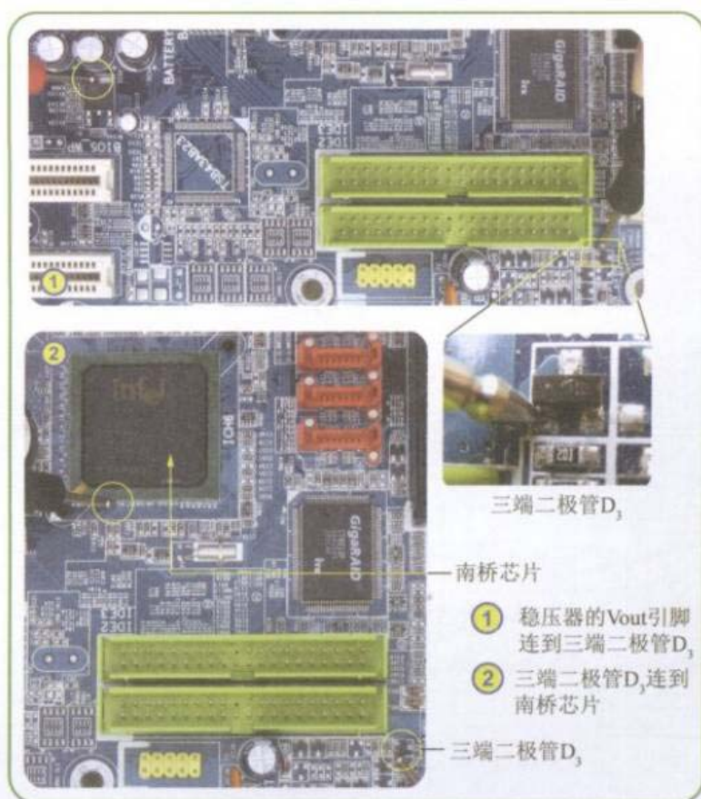
图7-18 测量稳压器Vout引脚到南桥的线路
