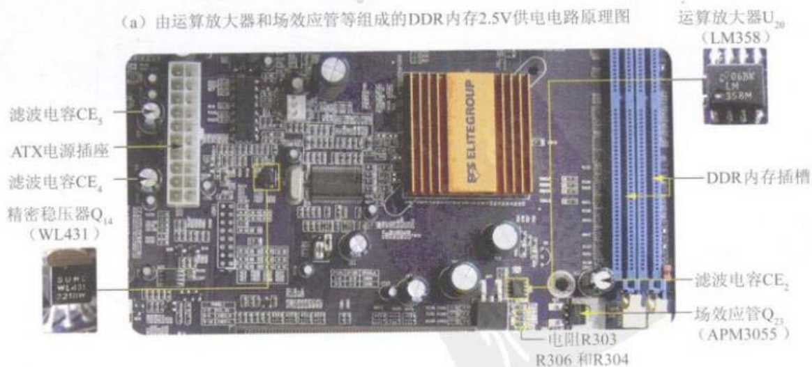
(b) 由运算放大器和场效应管等组成的DDR内存2.5V供电电路实物图
