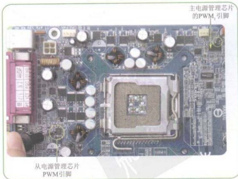
图8-59 主电源管理芯片的PWM 1 端连接到从电源管理芯片的PWM端的线路
