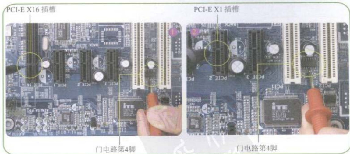
图10-19 测量门电路74HC14D第4脚到PCI-E总线的复位针脚的线路
