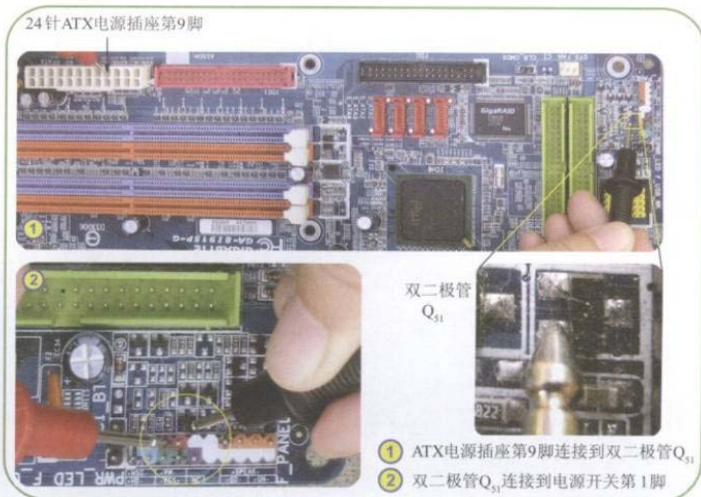
图7-22 测量从ATX电源插座第9脚经双二极管到电源开关第1脚的线路
