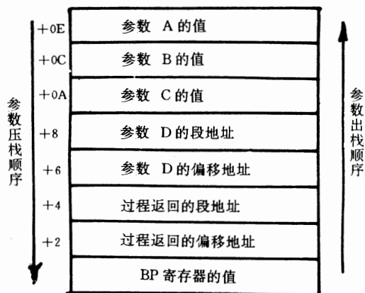
图 1 Turbo Pascal 远调用汇编程序 PROC 的堆栈情况
