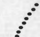
图1 类型1的点阵图 (数据: FF FF 00 FF FF 00 00)
