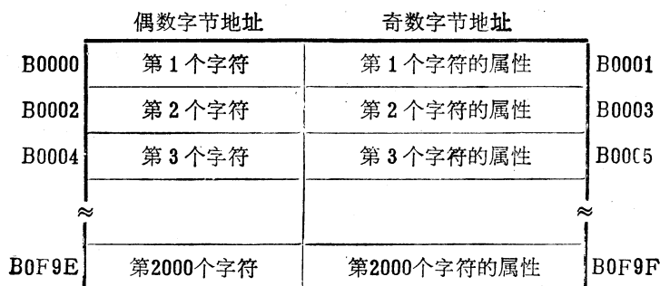
图 1-17 字符缓冲/属性存储器的布局
