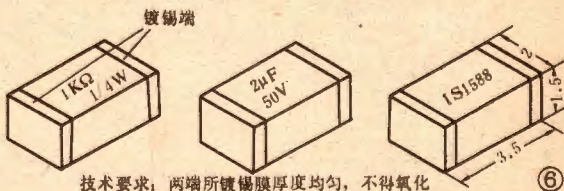
技术要求:两端所镀锡膜厚度均匀,不得氧化
