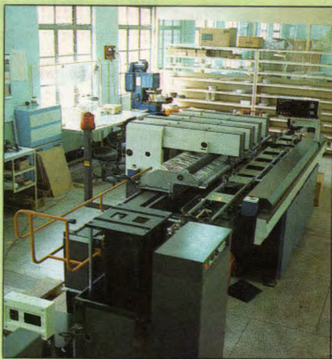
▲由日本松下公司引进的彩电电子生产线主要设备之一——电脑程序全自动粘片机。
