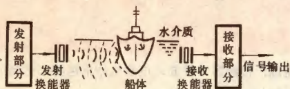
图5 直达式超声船舶探测原理图
