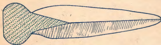
④导弹驱逐舰的球鼻艏
