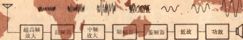
④ 超外差调频收音机方框图
