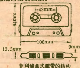
飞利浦盒式磁带的结构
