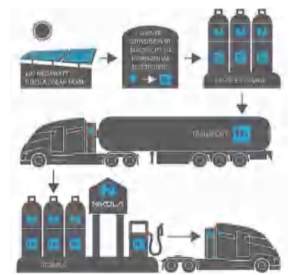
氢能生产供应闭环——完成以太阳能发电制氢、储氢、加氢,尼古拉正在尝试解决氢燃料的成本问题
