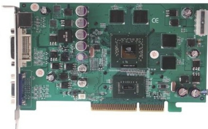
英伟达采用的AGP-PCIe转换芯片（GPU下方芯片）
