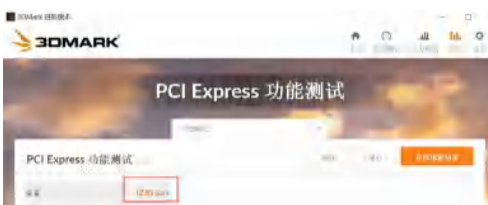
使用 Intel 酷睿 i9 10900K 平台,RTX 3080 在 3DMark 的 PCIe 带宽测试中成绩为 12.93 GB/s
