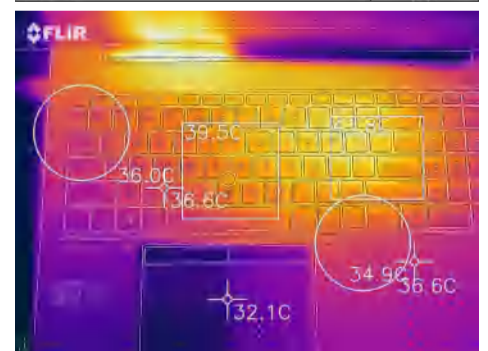
高负载下C面的温度不高,风扇噪声较低
