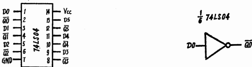
图 I .13 74LS04 六反相器的引脚图
