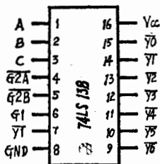
图 I.10 74LS138 八中取一译码器引脚图及真值表
