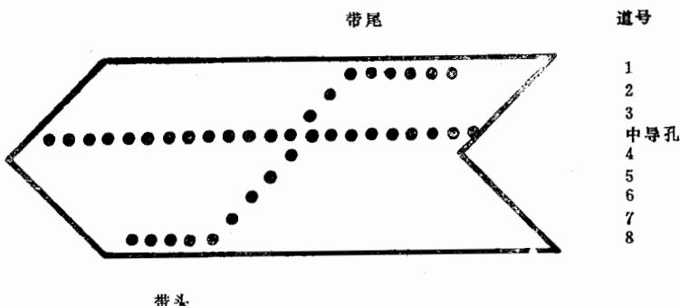
第 8 道(在它上面有孔的话)表示带头/带尾(LDR/TRLR; 8 进制数为 200, 16 进制数为 80)。第7道(在它上面有孔的话)表示接下来的 4 个记录(字)是地址信息。数据信息和地址信息均被分为一个 2 位字节和一个 6 位字节。所以，一个127(hex 57)的代码将以下面的形式出现：
