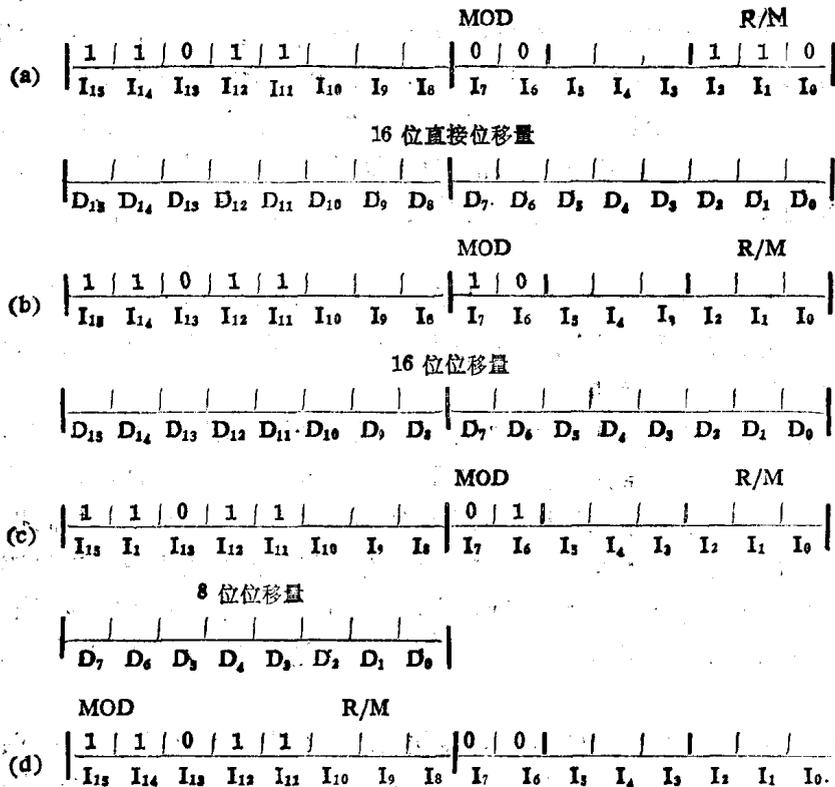
图 10.19 访问存储器的换码指令格式
