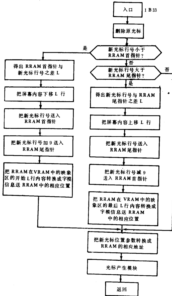
图 6-4 圆形方式光标定位模块流程
