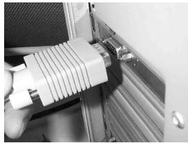
将显示器上的数据线连接到显示卡上
