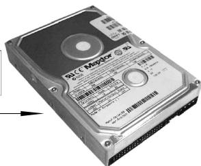
Maxtor的钻石四代3.5英寸高性能硬盘,专为高级桌面电脑设计。它采用了MR磁头、PRML、数字信号处理(DSP)以及Maxtor独有的Formula 4HAD(四碟片组合体)等新技术,这使得它拥有单碟2.88GB和11.5GB的最高容量,以及快达9.0ms的平均寻道时间。钻石四代硬盘采用Ultra DMA/33接口,达到更高的容量与更优异的性能,可以获得更经济实惠的单位成本。
