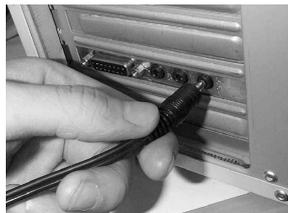
连接音箱的音频输入线到声卡
