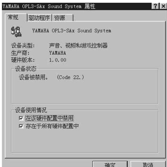
将 YAMAHA 声卡禁用，就可以单独让 PCI 声卡发声
