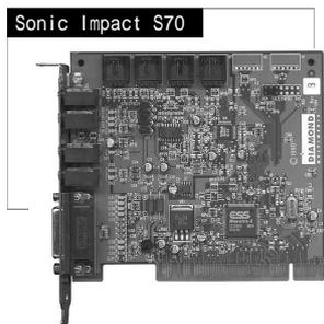
S70面向的是低端市场, 所以其价格在同档次的PCI音效卡中极具竞争力。虽然是面向低端市场的产品, 但S70的性能却丝毫不差。S70采用ESS的Maestro-2芯片, Maestro-2能提供极快速的处理速度和较低的CPU占用率, 采用64复音的硬件波表合成器, 可以在Win95里选择2MB或4MB两种容量的音色库, 而新的音色库可以到相关网站上下下载得到。波表内存使用的是计算机主存, 这也是S70价格低廉的原因之一。令我们感兴趣的是Maestro-2芯片全面支持DOS游戏, 改变了以前PCI声卡对DOS游戏不兼容的问题。S70拥有两个音箱插口, 但S70的四音箱与四声道不同, 它只能提供一种环绕的效果, 无法实现3D音效定位。
