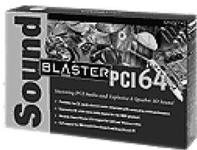
采用 ES1370 芯片的声卡都支持 DirectSound 和 DirectSound3D, 而且支持四声道输出。所谓四声道输出, 就是允许用户在声卡上连接两组立体声音箱, 每个音箱可以单独控制。这样声音就可以从左前、左后、右前、右后的方位上发出来, 以此来增强 3D 音效定位。虽然 DirectSound3D 是主流的 3D 音效 API 标准, 但是目前的游戏多为 A3D API 而设计, PCI 64 这类声卡则利用将 A3D 指令转换为 DirectSound3D 来模拟 A3D 效果。由于这种转换是由驱动程序来完成, 所以会加重 CPU 的运算负担。
