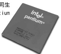
Intel Pentium 处理器是真正的第五代 CPU, 它的工作频率有 60、66、75、90、100、120、133、150、166 和 200MHz 等几种规格。最初的 Pentium 60 以及 66 两种 CPU 的动作速度与系统总线速度
