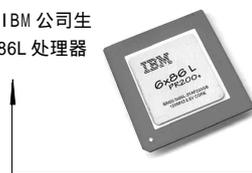
6x86L的供电标准与Pentium MMX差不多——一个2.8V的内核电压和3.3V的I/O电压。Cyrix计划让6x86L比它的上一代产品的能源消耗减少25%以上,从而使它的发热量更小,以增强其竞争性。
