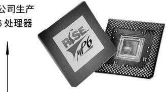
时，具有最低的电能消耗。看起来，它更适合于低端笔记本电脑市场。此外，mP6 也具有高级多媒体特性，同样适合于桌面电脑及 Windows 系统。
