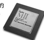
技术的支持,并采用0.35微米工艺制造。因此,它的发热量仍然不小。Cyrix为它作了一些改动,改动后的处理器本来也应该叫做6x86MX,但市场传言Cyrix为了不与Intel的“MMX”商标发生版权纠纷,就改名为6x86M II。6x86M II采用了全新的0.25微米工艺制造,发热量大大降低。6x86M II最大的特色是支持100MHz外频,除此以外它和6x86MX没有什么差别。
