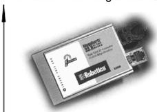
PCMCIA II 卡式系列, 笔记本电脑的搭档, 可以连接移动电话, 独具X-JACK专利技术, 不需要任何连接电缆, 可直接接驳电话线, 携带方便。也采用了Flash BIOS, 可以软件升级。
