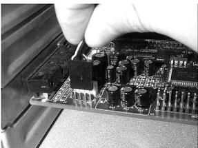
NEC 光驱的音频线适合于声卡上 SONY 接口的插座
