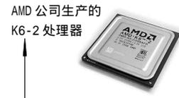
AMD 公开发布 K6-2 处理器是在 1998 年 3 月 28 日, 首批处理器规格有 266 和 300MHz 两种, 现已推出 333MHz 以及 350MHz 的规格。
