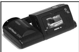
有的设计,即 Flash Track 旋转式变焦镜头,它将镜头及闪光灯相连,能作 270 度旋转,这样在任何角度都能使用闪光灯拍摄。相机正面有一高分辨率 LCD 取景器,取景、观看图像、设定参数都需通过它来完成。LCD 显示内容还包括照过的张数、剩余的张数、当前状态、日期和电量。
