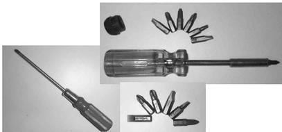
上图是较好的塑料柄螺丝刀，左图是普通的木柄十字螺丝刀，右图是塑料柄螺丝刀可以互换的螺丝刀头
