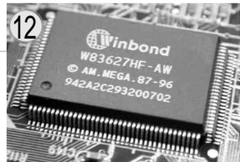
针对Intel的Camino、Whitney芯片组的输入/输出控制芯片W83627HF
