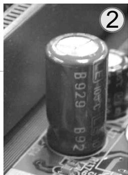
根据 Intel 白皮书规定，CPU 旁边稳压电容的总容量之和不能低于 9000  $\mu F$
