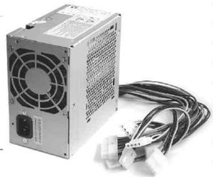
主机电源是每台电脑必备的动力来源，如果电源性能有缺陷，就会导致出现各种奇怪的电脑“病症”。为了预防隐患，并提高一些旧电源的品质，我们可以对主机电源进行改造。主机电源的改造可通过对电路的简单修改或更换一些元件（如电容）的方式，使电源性能得到改善。本文通过详细实用的操作步骤和配图，使读者也能掌握改造的方法，真正能从中受益。
