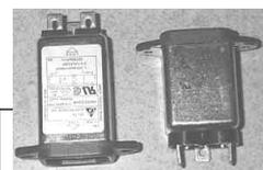
图 12 加装电源滤波器
