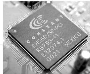
图 2 Conexant 公司的 R6795 芯片集成了 DSP、A/D 和 D/A 功能
