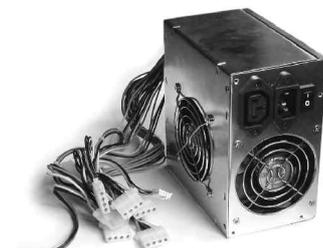
图27 金河田K7-395电源多出一个风扇，可辅助CPU散热，增强散热效果
