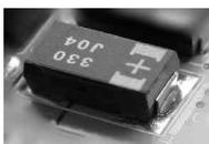
5 没有电解液的钽电容, 但它容量较小, 精度处理高
