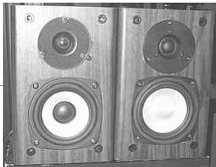
图5 这是M4.2换了M0401和T2001B后的对比照片(左边为改造后的音箱)
