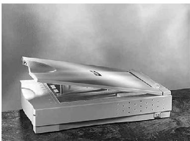
而且我们对扫描过程中的噪音表现也比较满意。ScanPrisa 640U采用了CCD的扫描方式，分辨率为600 × 1200dpi，最大扫描尺寸为297 × 210mm。
