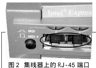
图 2 集线器上的 RJ-45 端口
