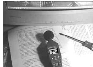
图19 改造后,电脑系统稳定工作时的噪声降到了34.8dB
