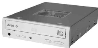
DMA/33 模式，缓存容量方面也为 128KB。Acer 产品有个特色，它的 CD 音量采用数字调节，与普通光驱采用模拟电位器不同，利用这一点便于识别 Acer 真货。Acer 品牌的光驱在市場有很高的占有率和较好的口碑。
