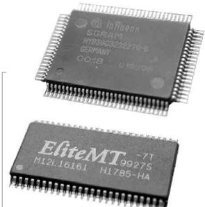
图3 SDRAM显存只有两排针脚，SGRAM显存有四排针脚
