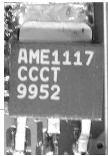
图10 转压芯片将 5V 电压转为 3.3V
