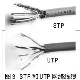
图 3 STP 和 UTP 网络线缆
