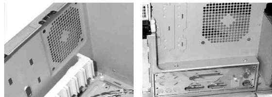
图28 机箱里一前一后、一进一出的通风窗口使机箱内的温度大大降低
