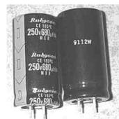
图 13 换装更高品质更大容量的滤波电容
