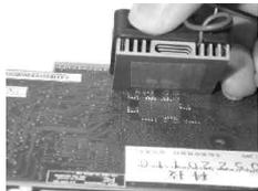
图19 线路板上应该没有其它的电阻、电容，否则粘不上去
