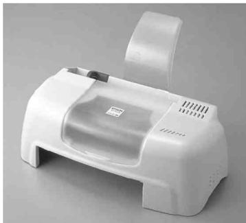
非常娇小, 并且没有一个操作按钮, 所有的相关操作都通过电脑里的软件来控制。即便是要更换墨水盒, 也是通过软件, 电脑会告诉用户何时该更换墨盒, 以及该更换哪个墨盒。另外, 由于这台打印机在接通了电源以后都是默认开启的, 因此它还特别加入了节能功能, 在打印完成或没有打印任务的时候, 打印机会自动进入睡眠状态, 不仅能省电, 而且还间接延长了机器的使用寿命。
