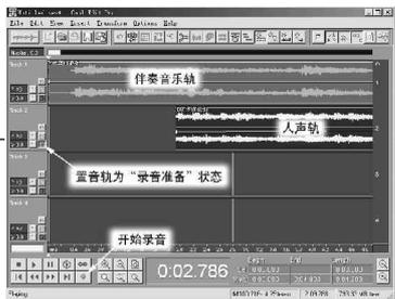
图18 将伴奏音乐和演唱人声分别录制到不同的音轨中
