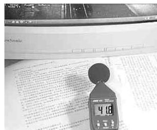
图18 改造前,电脑系统在稳定工作时的噪声是41.8dB
