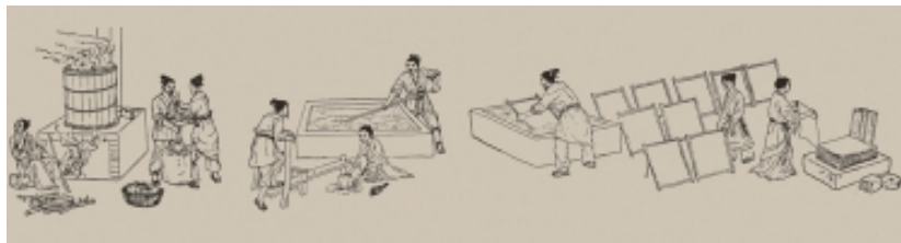
汉代造纸工艺流程图
