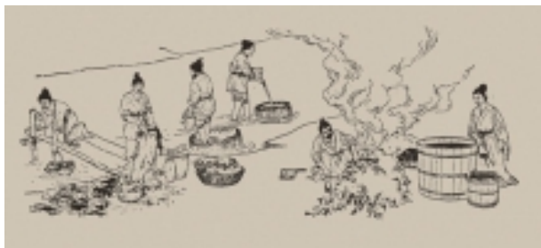
汉代造纸工艺流程图
