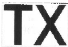
图 6-39 水平线与垂直线在计算机屏幕上显示效果很好,但显示对角线就出问题了。字母 X 和大多数的斜体字都是用对角线画成的
