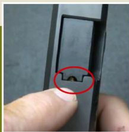
枪管尾部的缺口特写，膛内有弹时，可通过该缺口看到弹壳底缘
