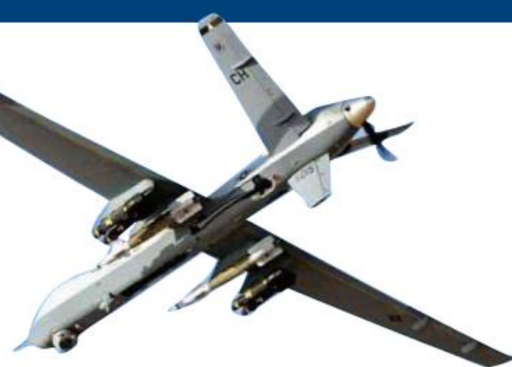
MQ-9“收割者”无人机可挂载4枚导弹和2枚炸弹
