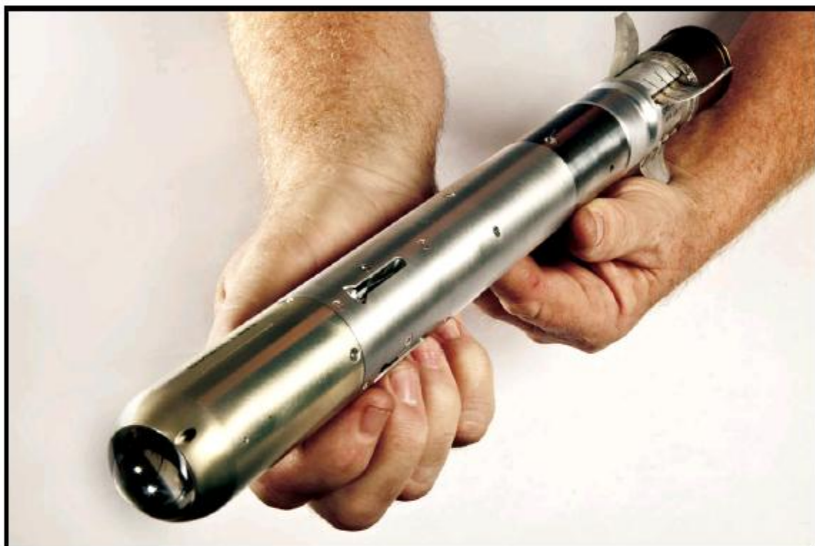
40mm“矛头”导弹口径40mm，长432mm，质量0.9kg，射程达2.4km
