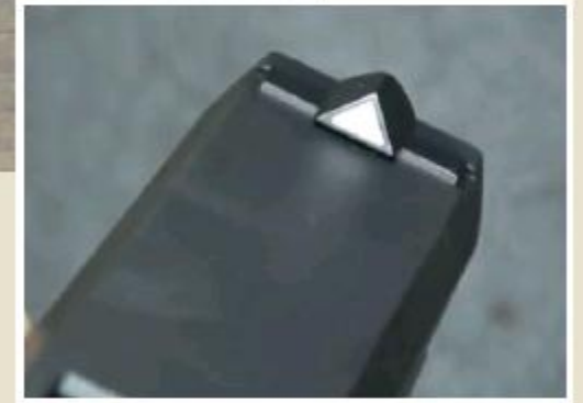
三角形准星特写，后方有氙光管
