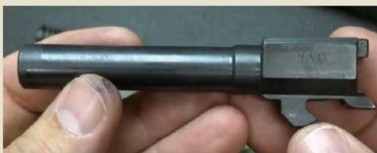
枪管特写，该枪所有金属部件都经过了斯太尔专利的“Mannox”表面处理工艺
