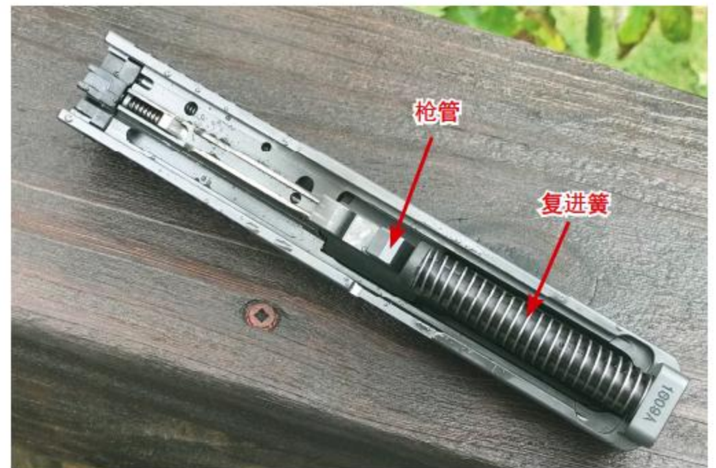
套筒内部结构特写，可见枪管及复进簧
