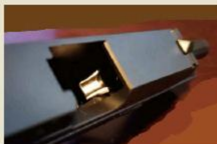
供弹坡部位特写，供弹坡经过抛光处理
