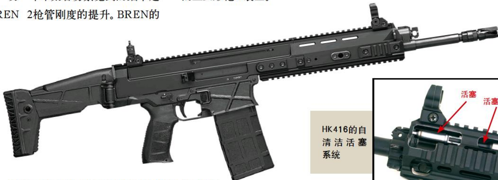
BREN 2 BR采用4对螺钉将更长更重的枪管与机匣固定
