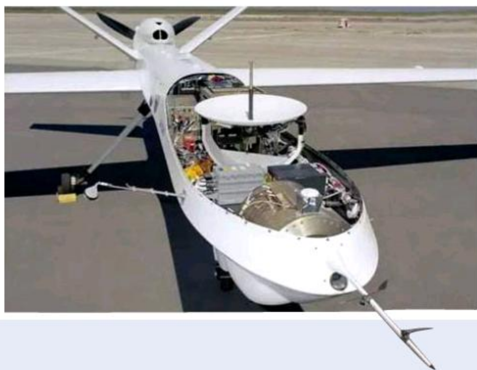
MQ-1无人机的机头卫星通信天线
