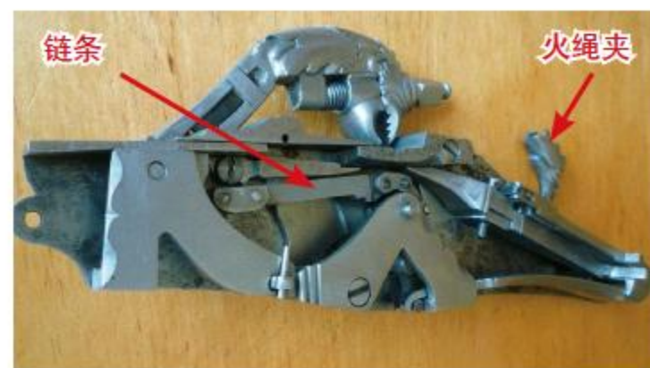
西班牙的两种特别的簧轮枪枪机。其通过后拉火石夹的动作，联动链条使钢轮旋转，以压缩主簧。其中，下图的枪机继承火绳枪枪机
