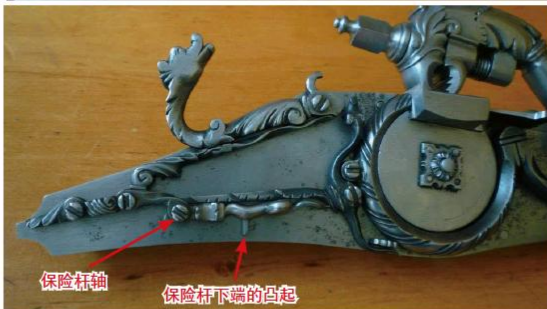
设有外置保险杆的簧轮枪枪机。保险杆可手动绕其轴旋转，保险杆下端的凸起插入上图中的圆环内，阻挡第一阻铁旋转，从而实现保险
