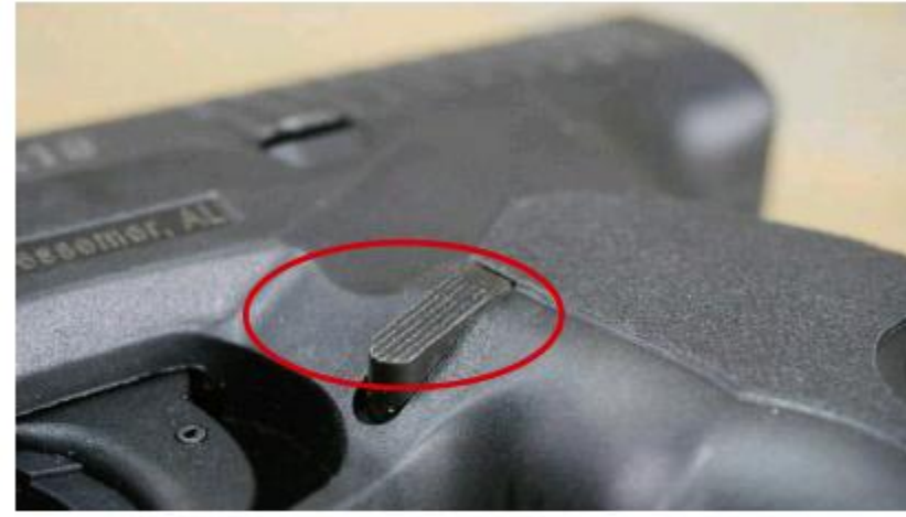
弹匣卡笋特写，表面加工有横槽状防滑纹
