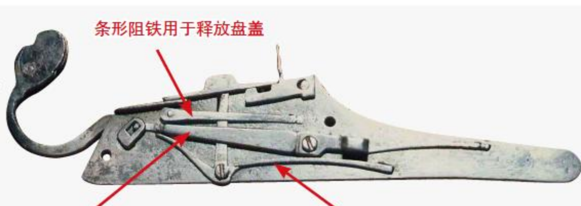
后拉火绳夹时，此杠杆挤压盘盖下部的长臂，使盘盖打开，同时上推盘盖簧，为盘盖关闭储备簧力
