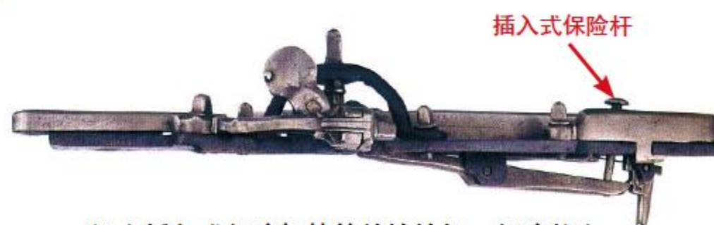
设有插入式保险杆的簧轮枪枪机。保险状态时，保险杆插入第二阻铁的孔中
