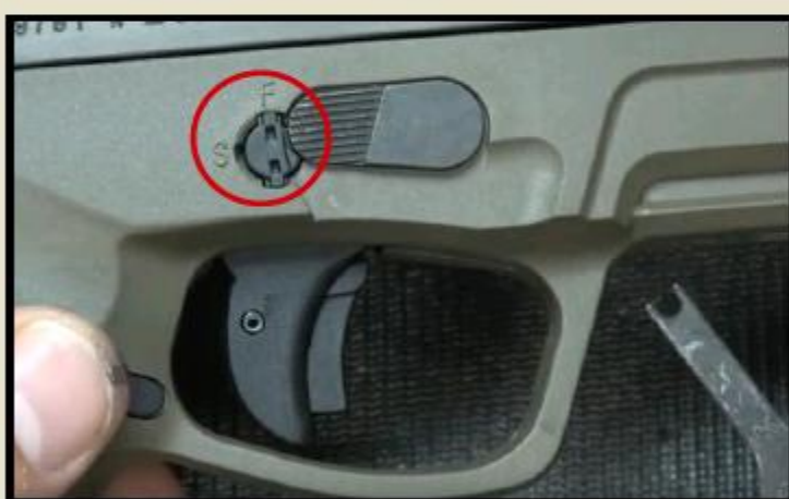
枪身分解杆后面的安全锁设计可以有效防止儿童意外击发枪械，但千万不能将钥匙弄丢
