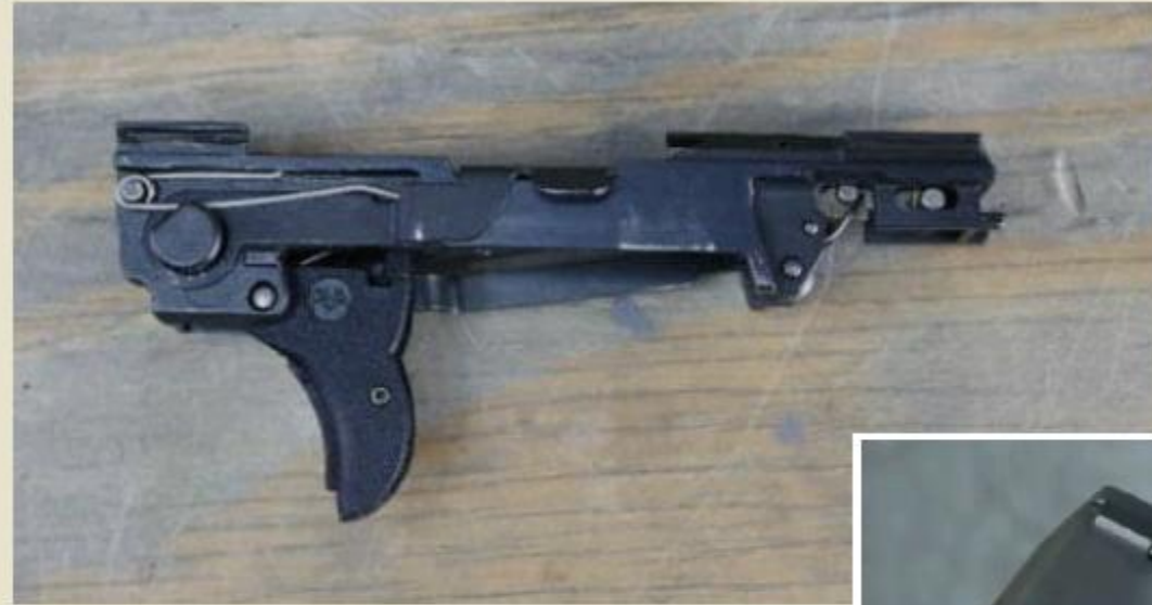
从套筒座上取出的发射机组件
