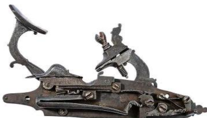
意大利打火枪枪机，采用了不同以往的设置扳机
