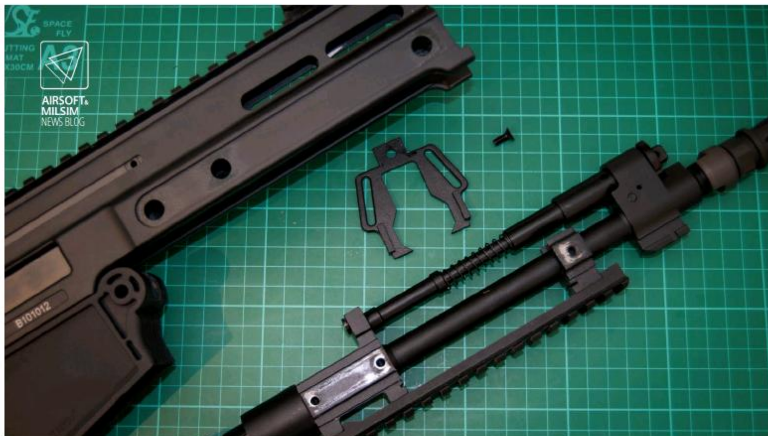
BREN采用3对螺钉将枪管组件固定在机匣上，BREN 2依然延续了这种方式
