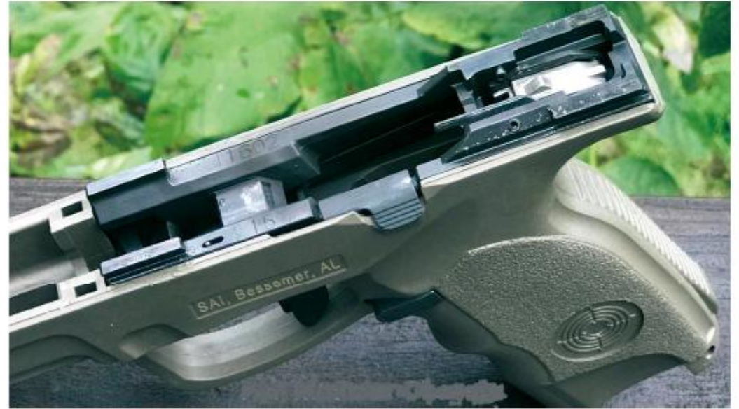
发射机组件安装在套筒座内状态
