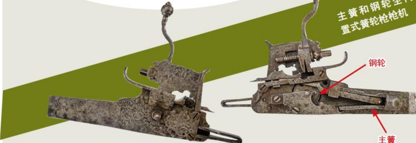
主簧内置钢轮外露式簧轮枪枪机
