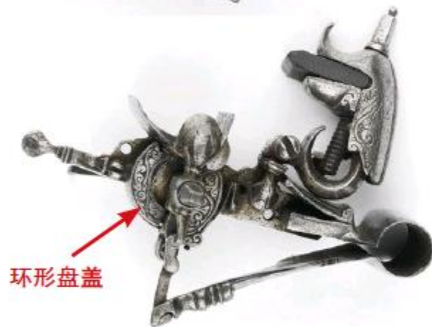
葡萄牙簧轮枪枪机上环形盘盖，其可以围绕钢轮轴转动，也兼有保护钢轮的作用
