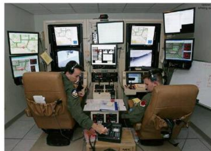
MQ-9无人机的后方地面控制站
