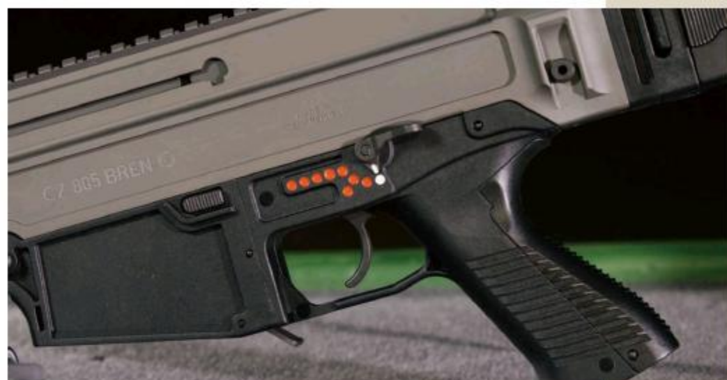
▲ BREN的快慢机设有保险（1个白点）、半自动（1个红点）、两发点射（2个红点）和全自动（5个红点）4档功能
