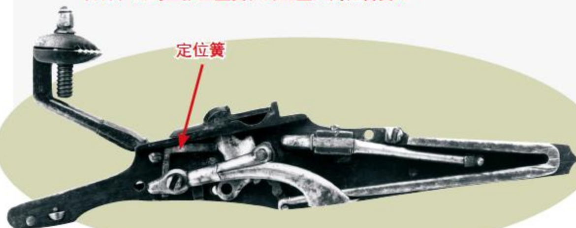
后拉火绳夹时，此杠杆挤压盘盖下部的长臂，使盘盖打开，同时上推盘盖簧，为盘盖关闭储备簧力
