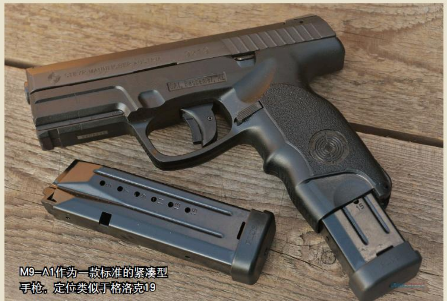
斯太尔M9-A1手枪的套筒特写，顶部两侧有大的斜角。注意箭头处抽壳钩前端的小凸起
