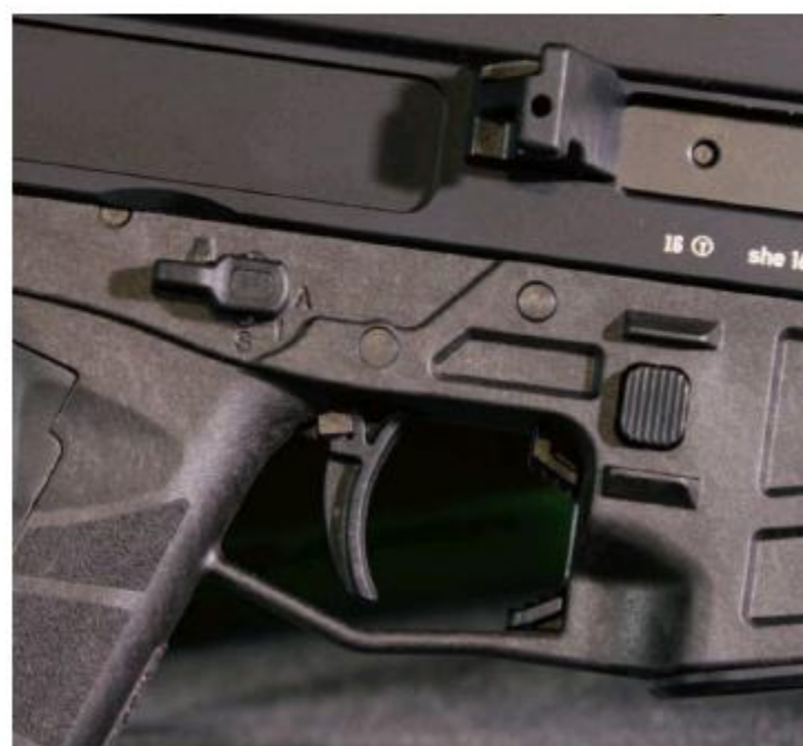
BREN 2的快慢机取消了前代BREN的两发点射档位，仅保留保险(S)、半自动(1)和全自动(A)3档功能
