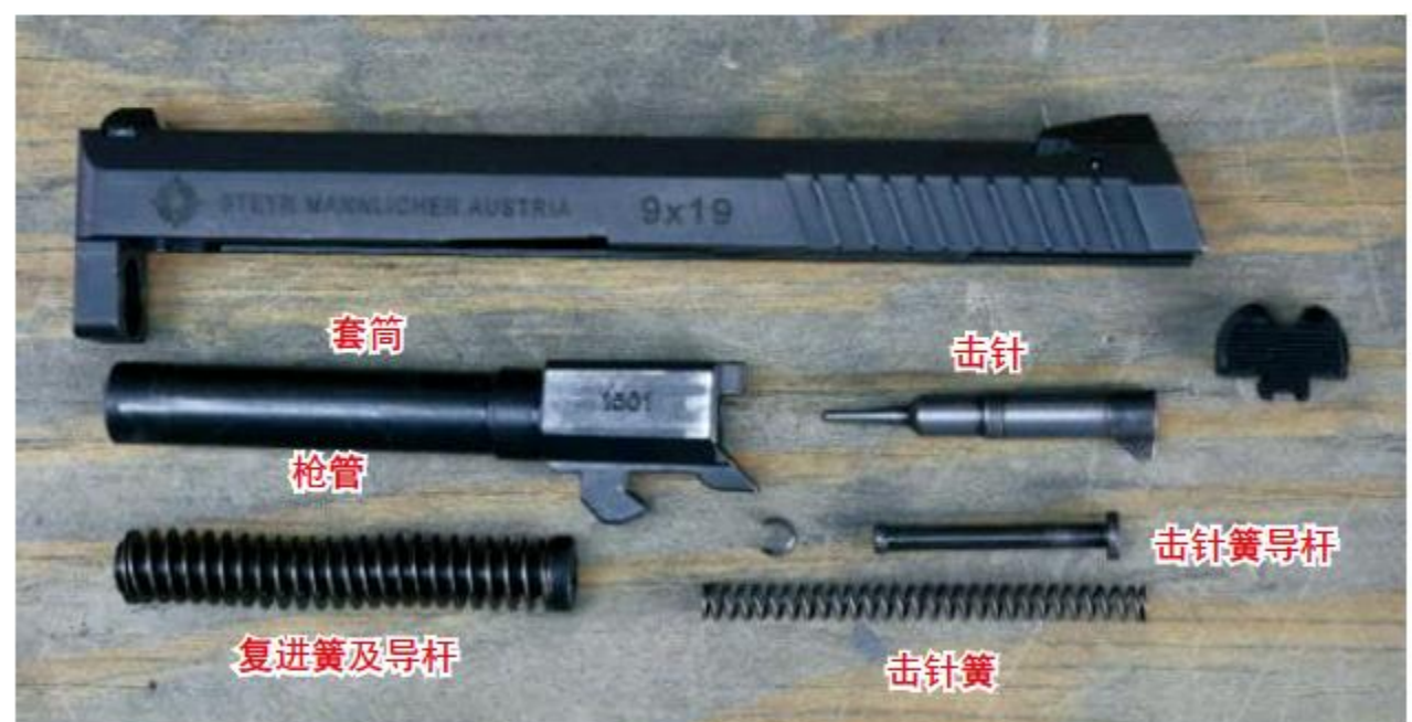
套筒、枪管、击针及击针簧、复进簧及导杆完全分解状态
