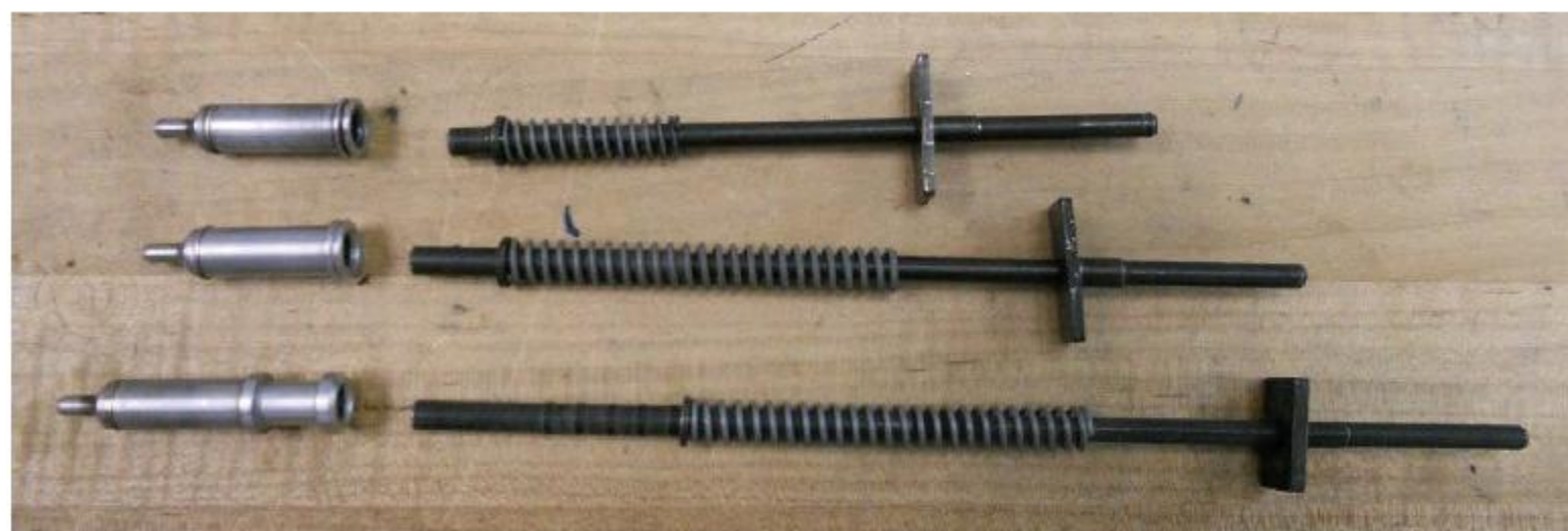
G36系列步枪采用细长的活塞杆，对制作材料有较高要求
