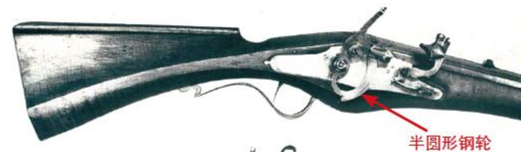
设有插入式保险杆的簧轮枪枪机。保险状态时，保险杆插入第二阻铁的孔中
