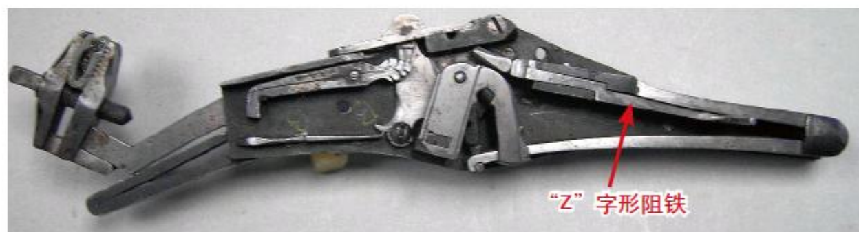
簧轮枪枪机上的“Z”字形阻铁
