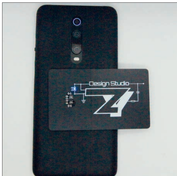
图 10 将名片靠近手机 NFC 识别区，LED 亮起
