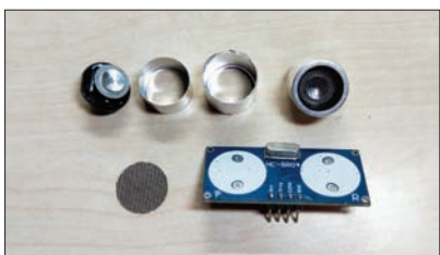
图 7 拆解超声波传感器
