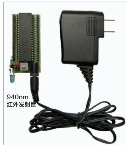
■ 图3 红外光发射电路连接实物
