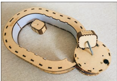
图 9 使用热弯的白色的亚克力板作为台灯的透光板
