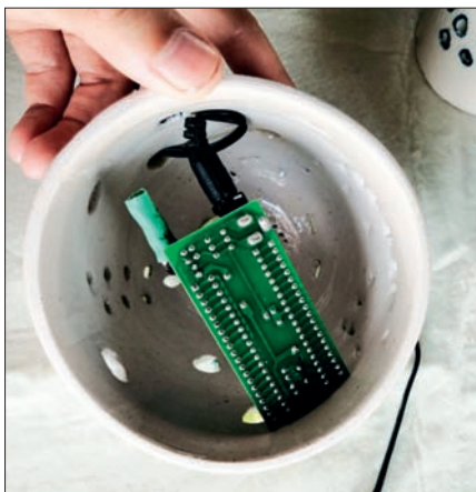
图 9 红外光发射电路
