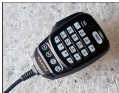
图 8 电台标配的 SSM-85D 话筒
