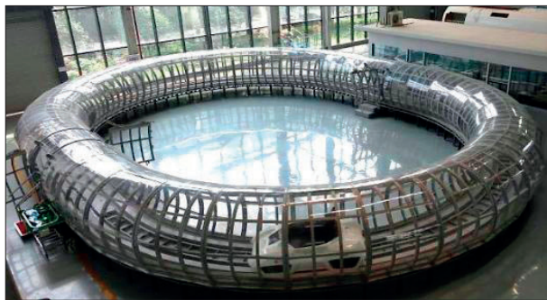
■ 图 3 西南交通大学搭建的超导磁悬浮列车实验线平台
