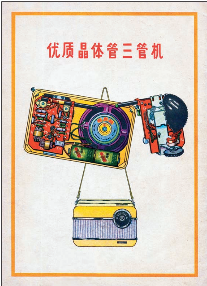
图 10 1963 年第 8 期《无线电》杂志刊登的《优质晶体管三管机》外观及内部元器件布置彩图。电路中大多数元器件布置在铆钉板上
