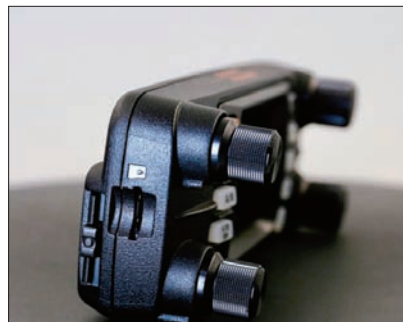
图 7 机头控制面板上的 Micro SD 卡插槽
