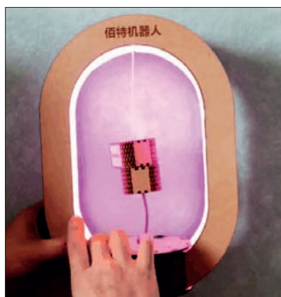
图 4 用手触摸传感器，切换灯带颜色
