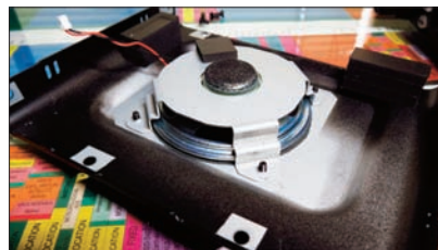
图 4 机身内部采用了 65mm 的外磁式纸盆扬声器
