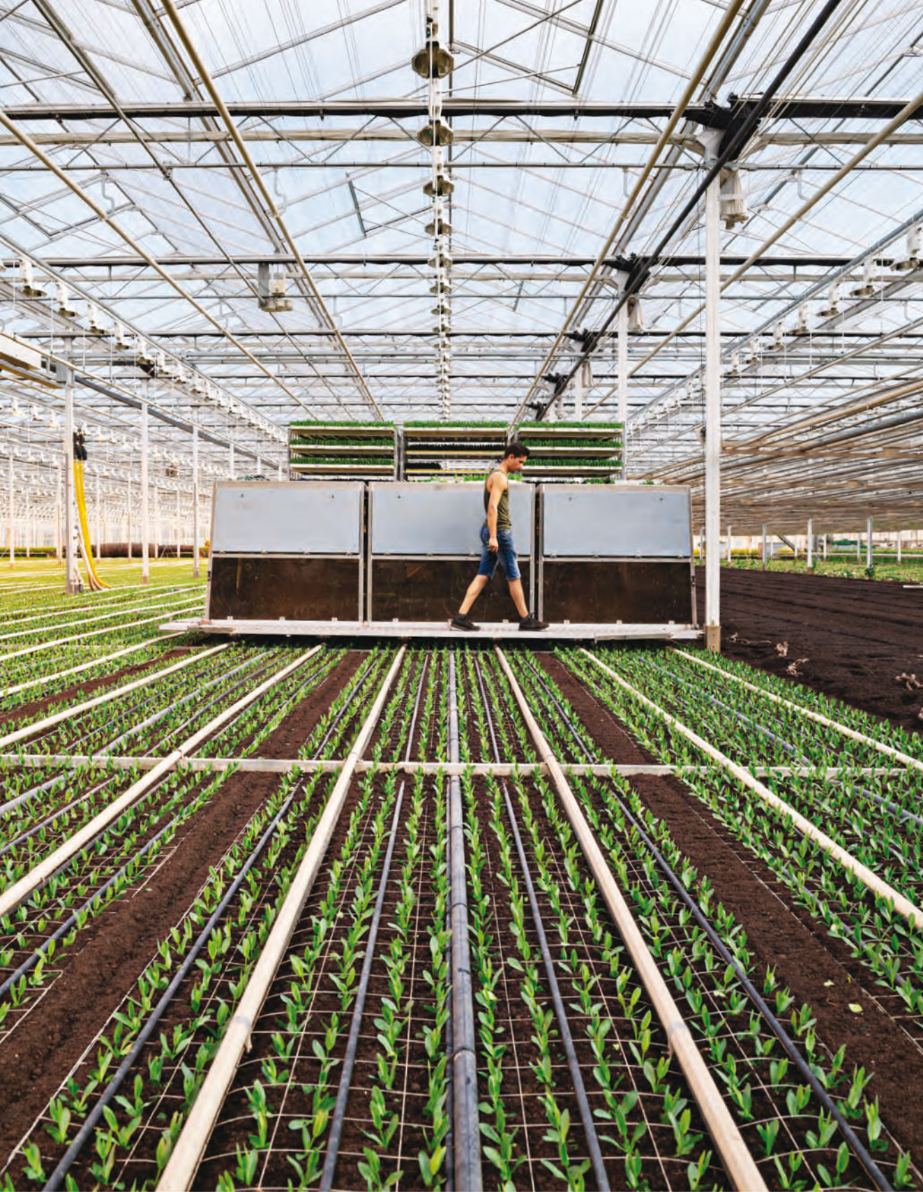
荷蘭普德羅延的瓦爾奇茲苗圃園中，ISO集團（ISO Group）製造的三臺機器人每小時種下1萬8000株剛長出來的花苗，僅由一名人類工人監督（左）。在荷蘭卡特沃德的亨利威利農場（右），一頭母牛走入Lely Astronaut A4機器人中。母牛走進來時，機器人會掃描牠的項圈，如果牠確實到了需要擠
