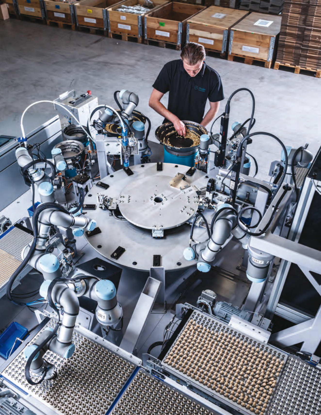
機器人夥伴有許多樣貌。在荷蘭愛因荷芬的流體儀器公司（Fluidics Instruments），一名員工和七具機器手臂共同組裝燃油與燃氣器（左）。這些協作機器人和傳統的工廠機器人一樣，動作精準又高效率，一個小時便可完成1000個噴嘴。但它們和舊機器人不同之處，在於能夠很快改變作業規格或是從
