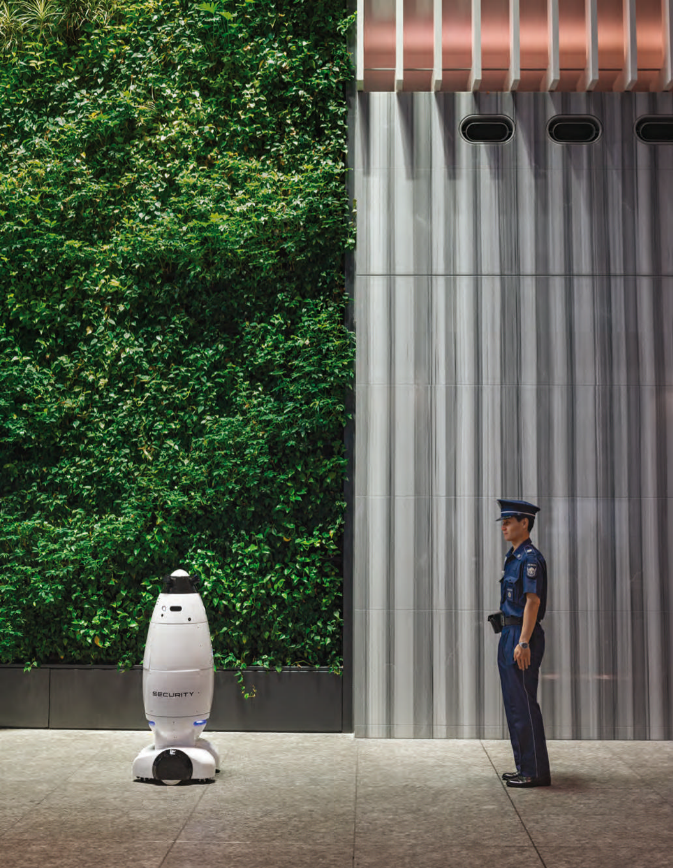
築工地和造船廠這類場所搬運重物。相反地，保全機器人SQ-2（右）沒有四肢，行動安靜而外型低調，高約130公分、重65公斤，裝配了360度攝影機、雷射測繪系統和一臺電腦，能夠自行巡邏。
