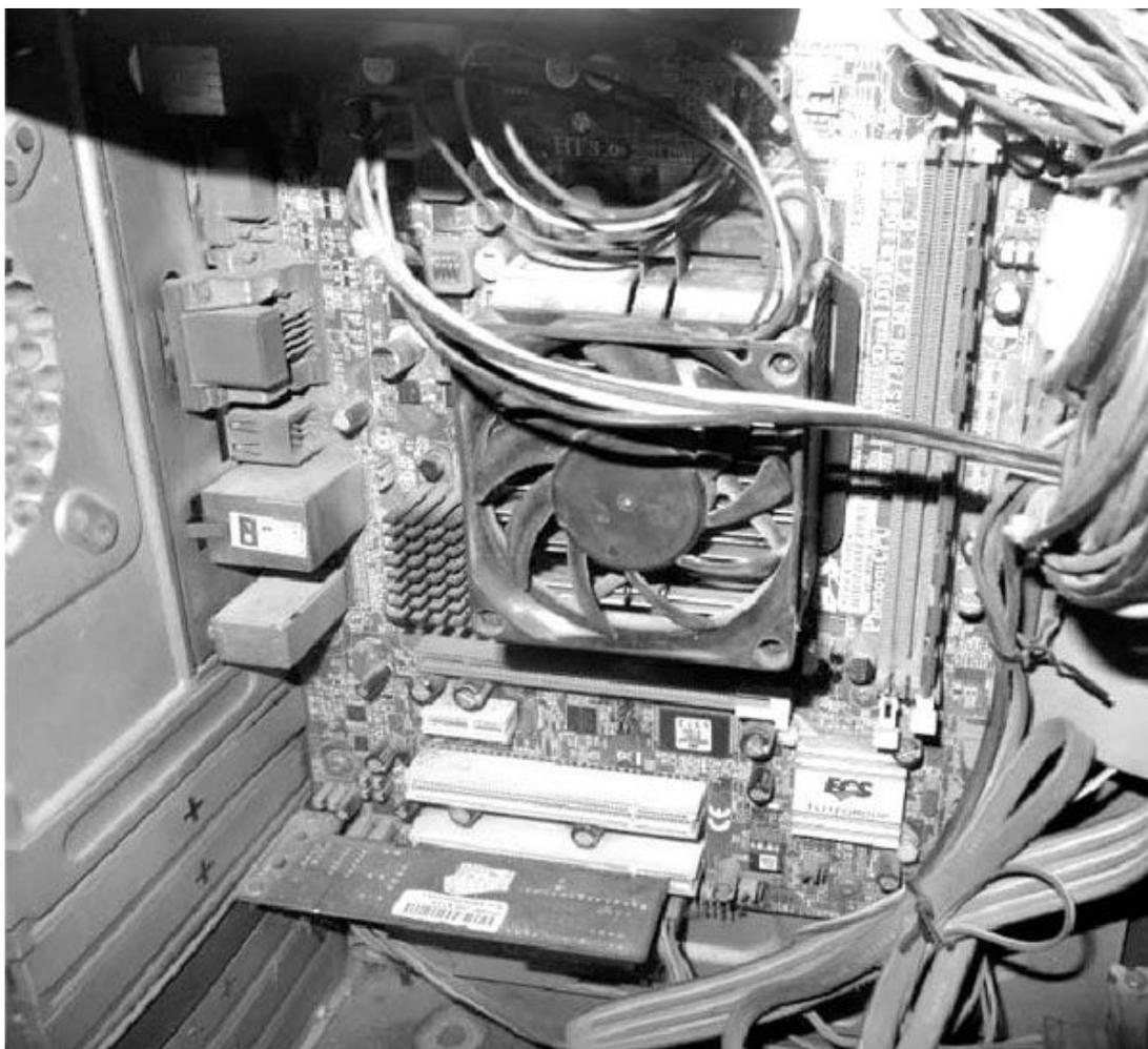
除了注意处理器、显卡风扇工作是否正常，定期清理电脑灰尘也十分必要，台式机内部如果灰尘过多，一定会阻碍散热器、散热风扇工作，甚至直接堵塞散热孔和散热片，完全阻断散热气流。笔者建议灰尘大的地区半年检查一次，空气比较好的地区一年检查一次即可。台式机清理灰尘自然容易，笔记本如果自认没有能力，可以找找当地的笔记本维修厂专业清灰（多用压缩空气吹灰，而不是拆机清灰）。但是这里要特别提示一点，台式机必须断电清理，而笔记本如果拆机清灰，则不仅要断电，还要将电池与主板断开，否则很容易造成硬件故障！
