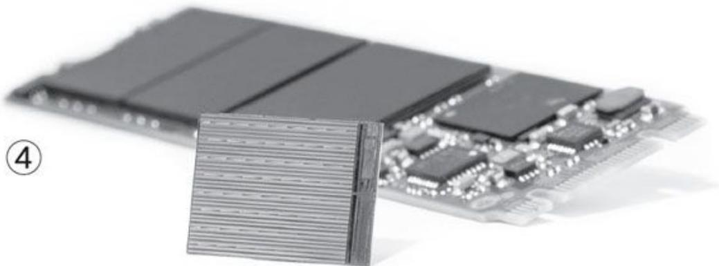
固态硬盘的闪存颗粒（图4）也是影响容量的重要因素，比如只要增加闪存颗粒就能直接增加固态硬盘容量（当然实际上会受到空间、主控芯片能力的限制）；此外TLC、QLC等越来越新的闪存技术让每个单元的存储数据量越来越大，而越来越先进的制造工艺则可以在每个颗粒中叠放越来越多的存储层，也都可以提升固态硬盘的容量。
