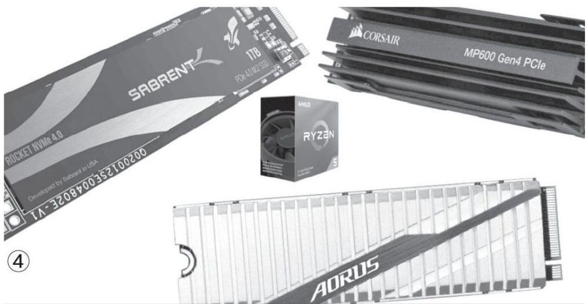
除了处理器之外还有一些配件要注意匹配，比如现在的M.2固态硬盘有PCIe 3.0和PCIe 4.0标准的，要是把PCIe 4.0固态硬盘（图4）插在PCIe 3.0 M.2接口上就发挥不了应有的速度。目前在消费级市场中，可以稳定支持PCIe 4.0的主板主要是新的AMD 500系列和部分AMD 400系列芯片组主板，英特尔主板基本都不支持。
