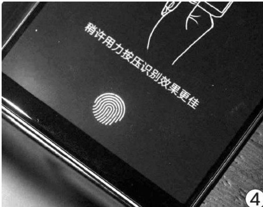
如今指纹识别技术已经与屏幕深度绑定：短期内只有采用OLED材质屏幕的手机才能用上屏下指纹识别方案（图4），而LCD屏幕手机则只能搭配侧置指纹（与电源键合二为一）或后置指纹设计。因此，大家不难发现同配低价手机大多以LCD+侧置指纹设计为主，不仅屏幕面板成本低，指纹模块同样可以省下不少银子。
