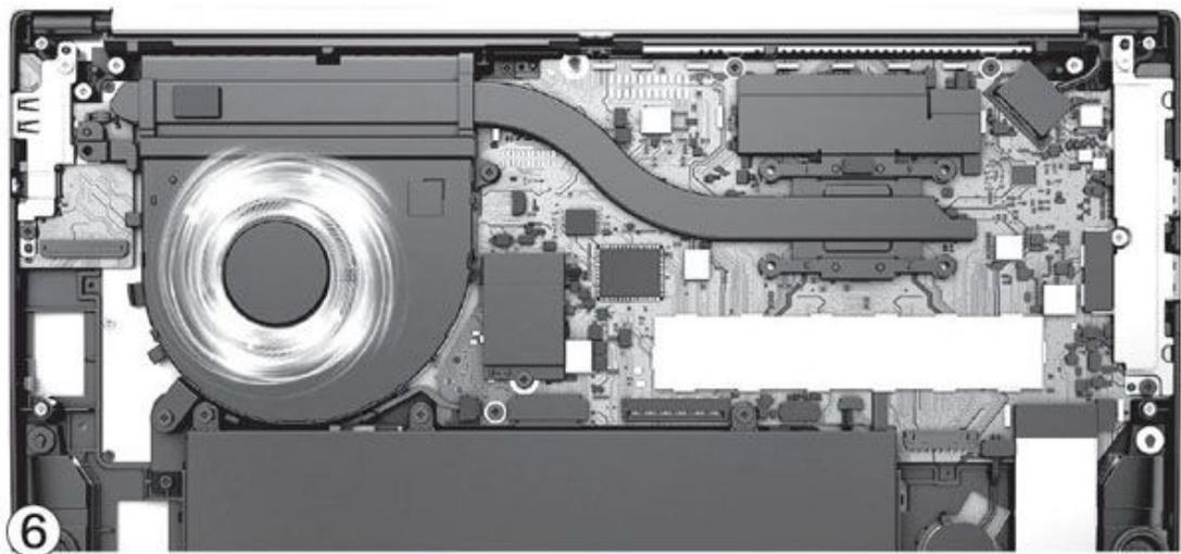
在升级潜力方面，两款机器都仅内置1个M.2插槽，想升级SSD就必须替换标配的。机械革命S2 Air内部配有2个标准的内存插槽，有需要的用户未来可以升级到16GB+16GB。RedmiBook14的内存则为板载设计，用户无法自行替换。在散热设计方面，机械革命S2 Air采用了双风扇双热管的散热模块（图5），RedmiBook 14为单风扇单热管（图6），足以让它们各自搭载的处理器稳定输出。
