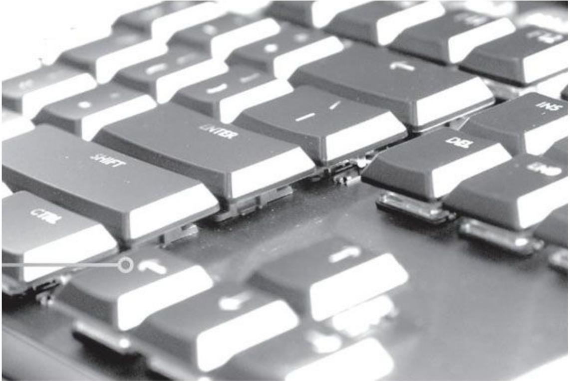
金属拉丝工艺的键盘上盖工艺、便于清理的悬浮式按键结构等在G913上得到验证的设计当然要保持。同时它还继续使用罗技GL矮轴，触发键程、亚力克数、噪声都比传统的机械键盘小了许多，很适合割舍不掉机械手感但又容易疲劳的用户，也更适合用于办公室、网吧等场合。
