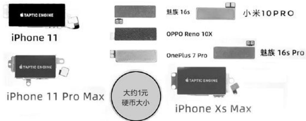
⑥ • 不同款手机采用的X轴线性马达拆机对比，一般来说体型越大振动效果越好
