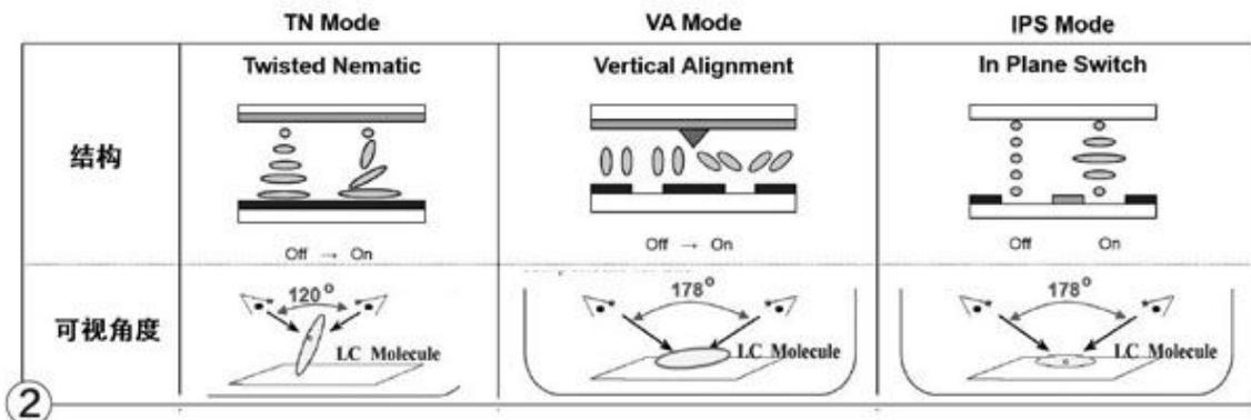
液晶面板显示画面的方法类似，都是背部安装光源，用电流操作每个像素下的液晶分子排列，控制透光量的多少，透过的光线穿过彩色像素后，就能“映射”出深浅不同的颜色了，而红、绿、蓝（RGB）三种颜色的像素组合，就能像调色盘一样给出我们看到的各种色彩了。IPS、VA和TN面板的主要区别就是液晶分子的排布方式（图2），其中TN面板是通过扭曲液晶排列来控制透光量，动作最快但精度最差，可视角度也差；VA则是控制液晶分子的倾斜度来控制透光量，精度好，可视角度大，变化比较慢。相对来说，采用液晶分子水平旋转方式的IPS面板在各方面的表现都介于中间，因此最具有改进潜力，也被目前的显示器厂商广泛接受。
