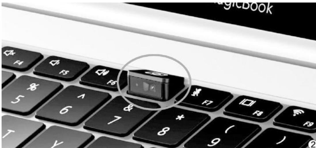
很多笔记本厂商已经预想到摄像头存在安全隐患，所以在设计之初就为它准备了物理开关，通过拨动它就能挡住或移开正对摄像头的挡板（图1）。当摄像头被开关遮住时，再厉害的黑客也束手无策。这类设计多见于商务笔记本，少数消费级笔记本也有所涉猎。华为旗下的部分笔记本为了追求超窄边框，不得不将摄像头隐藏在键盘内（图2），使用时需要按下才能弹出镜头。这种设计其实也具备很好的防偷窥效果，不弹出就无法使用。
