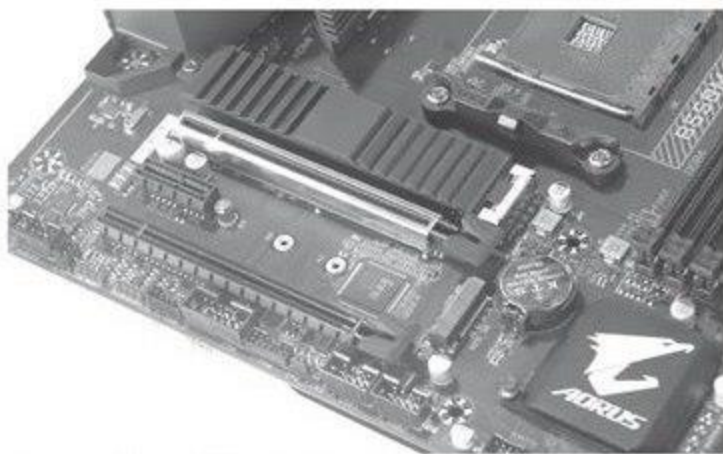
• 双M.2接口，其中一条为PCIe 4.0 ×4通道且带有散热片，可为用户提供最高7GB/s以上的可用带宽，另一条来自芯片组的M.2接口则拥有PCIe 3.0 ×4通道。此外两者之间的加固装甲显卡插槽也非常吸引眼球
