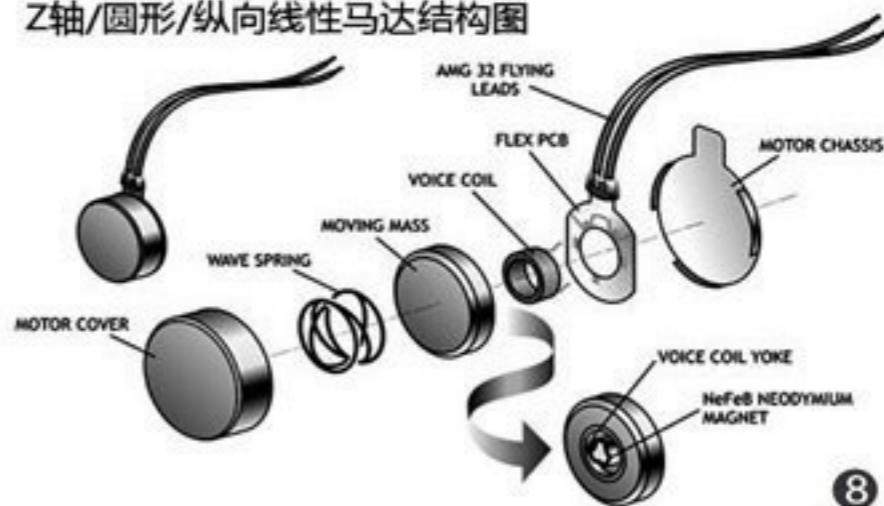
Z轴/圆形/纵向线性马达结构图
