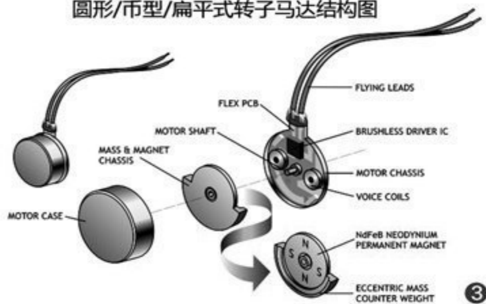
圆形/币型/扁平式转子马达结构图
