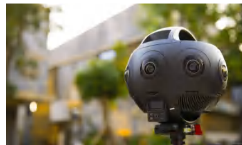
Insta360 Titan使用了多达8个M4/3 CMOS+广角镜头组合,可拼接11K分辨率VR全景视频
