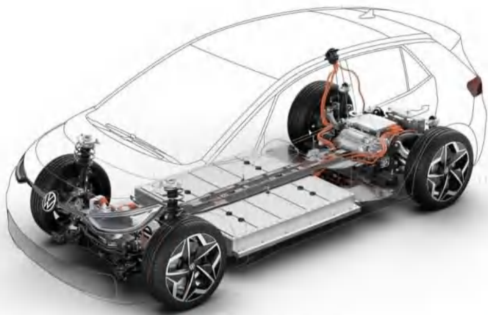
MEB平台是大众集团走向电动化的核心平台,它的优劣决定着大众在下一阶段战略的成败。大众专门为MEB开发的永磁无刷电驱电机,代号APP 310,电机峰值150kW(200马力),最大可以提供310Nm扭矩
