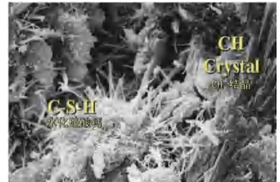
水泥本体——水化硅酸钙晶体
