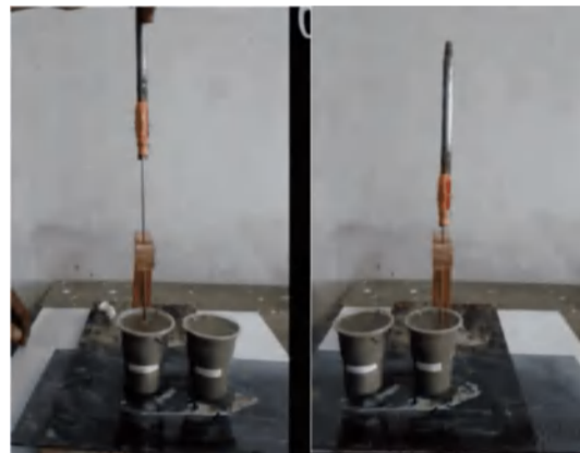
右边水泥加入白糖,60分钟后左边凝固时右边还没有凝固
