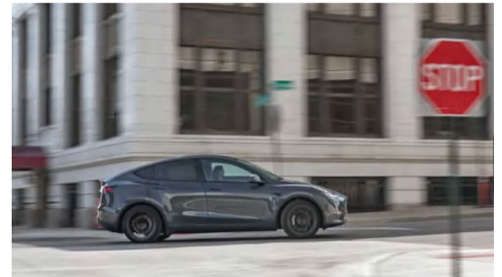
特斯拉Y是新推出的紧凑型SUV,在时速75英里(120公里)的高速公路测试路线上,得到了220英里的真实里程,仅比Model 3少10英里
