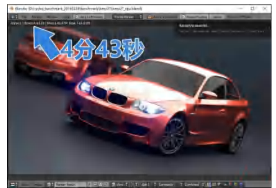
▲Blender渲染，i7 10875H全程依然是75W输出，总耗时4分43秒，即283秒。对应的，75W输出的i7 9750H总耗时为379秒，60W输出的i7 9750H则要402秒——Y7000P的i7 10875H效率提升25%和30%！
