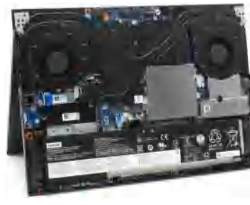
▲Y7000P 2020的内部,规整且整洁,内存有金属罩遮蔽,提升了可靠性和安全性;SSD和无线网卡也都进行了金属遮蔽;另外,该机还能升级一条M.2 SSD;电池为80Wh,作为主流定位机型,这个容量算比较大的
