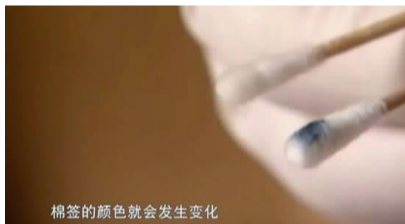
棉签的颜色就会发生变化 四甲基苯胺可以与血红蛋白发生颜色反应，帮助警方判断所提取样本是否为血迹
