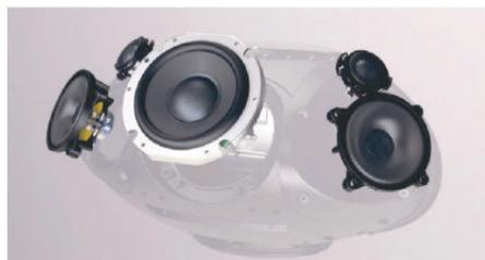
上 內部單體採用三音路的配置，每顆單體都有獨立的功率驅動，經過計算的單體指向，能讓喇叭具有很出色的聲音擴散性能。
