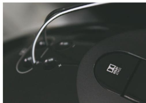
↑ Sib Evo 2.0特殊的「夾線式」喇叭端子，透過端子下方的開關打開端子閘門，將喇叭線固定在內。也因如此，Sib Evo 2.0的喇叭線只能選擇線徑較細的裸線。
