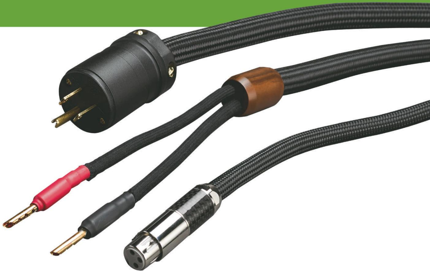
有RCA與XLR訊號線、喇叭線、電源線；另外，雖然在官網上並沒有顯示，但Evolution系列其實也有推出75歐姆的數位同軸線以及喇叭跳線。根據有限的官方資料，Evolution系列線材可以彙整出以下幾個重點技術資訊：首先，導體採用的是UPOCC無氧銅，結構為單芯實心設計；導體有在惰性氣體環境下進行特定過程以慢速退火處理，讓導體表面平滑並且近乎沒有雜質與晶格間隙。再來就是導體外圍有批覆天然纖維並搭配有彈性的空氣管做絕緣之用，可以有效消除MDI失真。
