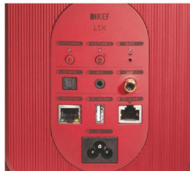
左 LSX以DSP晶片作時間、相位、頻率響應校正與數位電子分音，在數類轉換後以兩組D類功放電路個別驅動Uni-Q的高音與低音單體。低音反射式喇叭想獲得良好低端延伸，低音反射管口徑要夠大也要夠長，KEF把LSX的低音反射管做成彎的、這樣才能裝進它小巧的箱體裡。
