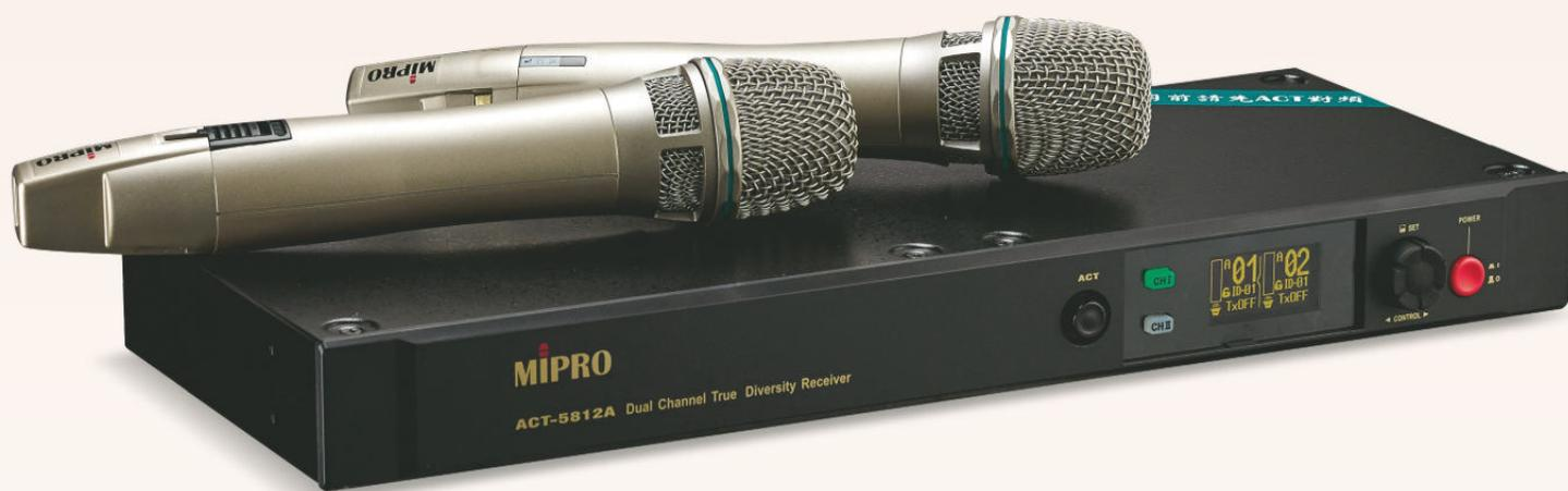
主要都是以5.8GHz頻段為主。ACT-5812A雙頻接收機正是如此，採用5.8GHz國際通用ISM頻段（5.725~5.850 GHz），以雙調諧器純自動選訊接收方式，讓訊號傳輸時能避開4G行動通訊設備的干擾，也可以和許多使用2.4 GHz頻段的無線產品錯開頻段，讓多頻道同時長距離傳輸不斷訊，在低干擾的情況下，使配備的無線麥克風可以獲得穩定、音訊品質好的傳輸效率。
